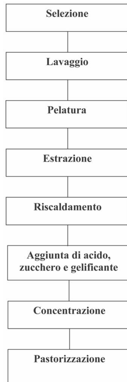
Fig. 4 - Flow sheet per la produzione di una confettura di fico d'India. Fonte (vedi bibliografia), Sáenz (1998).
