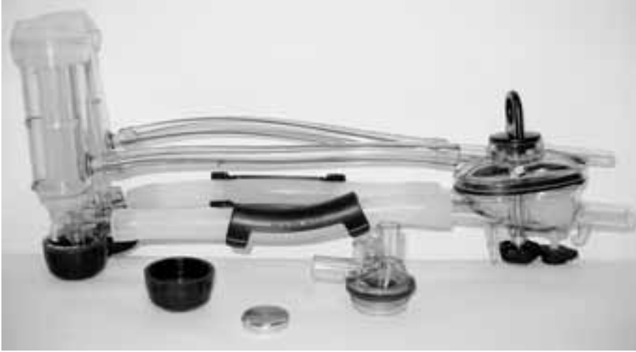
Fig. 8 Per stabilizzare il vuoto nel prendicapezzoli è consigliabile montare i tubi corti del latte con diametro interno di 10 mm e il dispositivo d'interruzione automatica del vuoto
