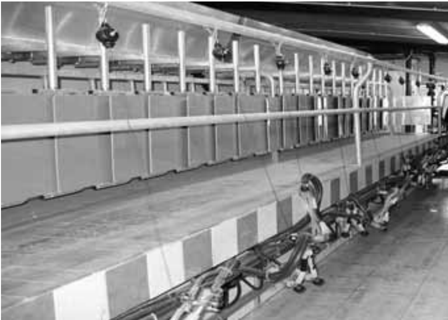
Fig. 9 L'impianto "a basso vuoto" è stato realizzato con l'obiettivo di mungere regolando il vuoto a 28-30 kPa
