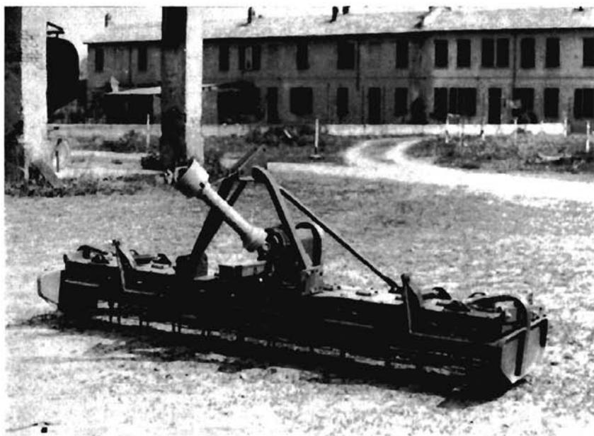
Fig. 2 - Erpice a denti rotanti.
