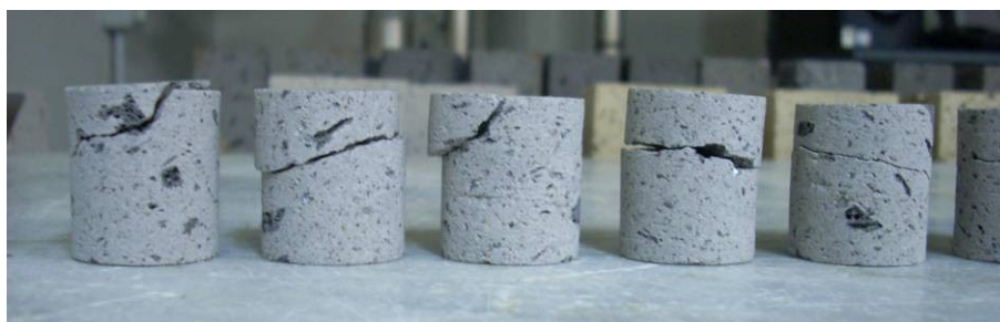
Fig. 6.3 - Provini cilindrici di IC gr dopo cicli di invecchiamento gelo-disgelo.
