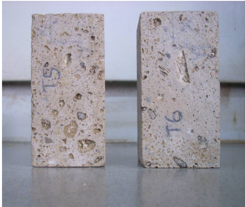
Fig. 6.30 - Provini di IC_{gi} trattati con una miscela di T-CON + T-VIN alla fine del test di cristallizzazione dei sali marini (dopo XV cicli).
