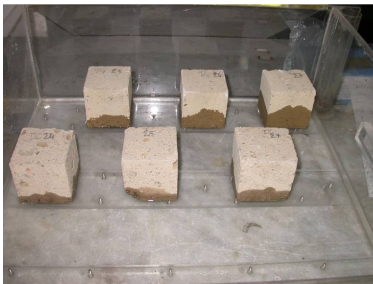
Fig. 4.16 - Provini di tufo adagiati su supporti durante l'esecuzione della prova di risalita capillare.
