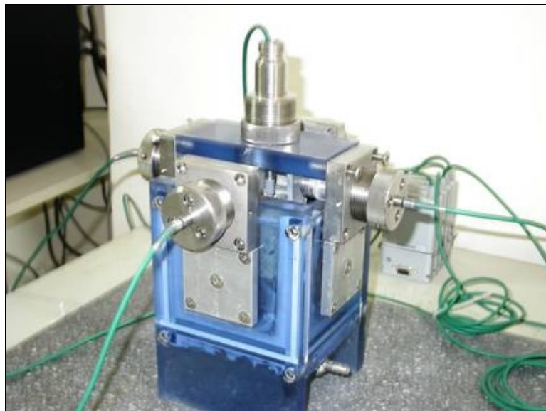
Fig. 4.22 - Apparecchiatura per la determinazione del coefficiente di dilatazione per immersione ( swelling test ).
