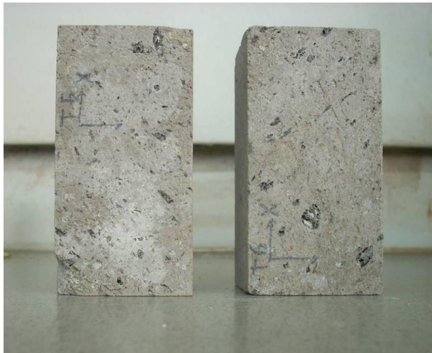
Fig. 6.31 - Provini di IC_{gr} trattati con una miscela di T-CON + T-VIN alla fine del test di cristallizzazione dei sali marini (dopo XV cicli).
