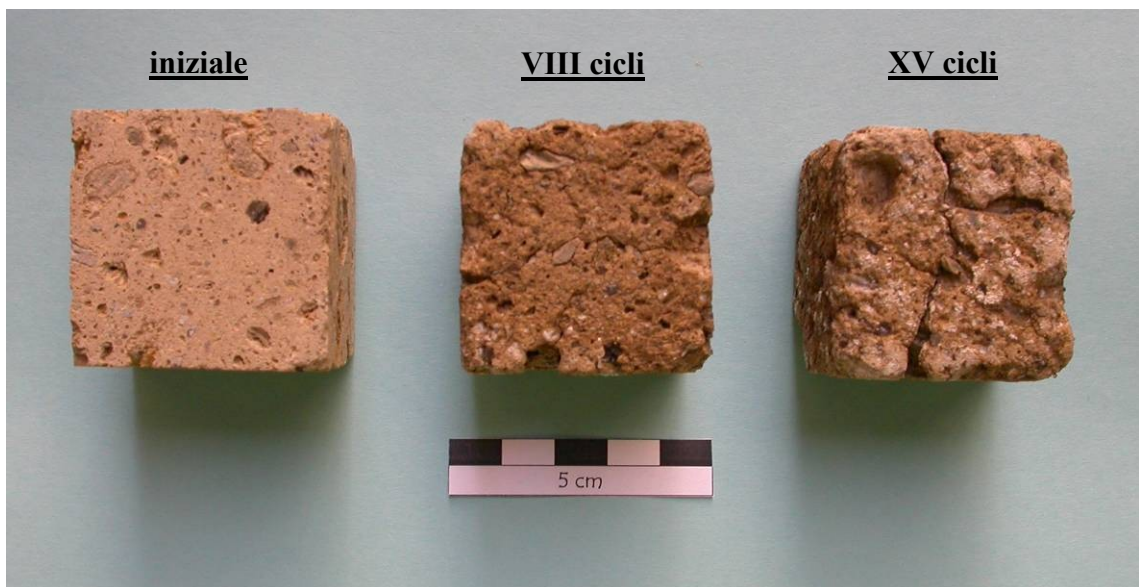
Fig. 6.10 - Evoluzione di un cubetto di IC_{gi} sottoposto ad invecchiamento mediante cicli di cristallizzazione di sali solubili. Anche in questo caso si nota un progressivo peggioramento delle caratteristiche del provino senza però raggiungere la totale disgregazione.
