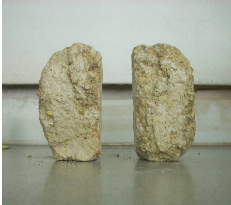
Fig. 6.23 - Provini di TGN trattati con T-CON alla fine del test di cristallizzazione dei sali marini (dopo XV cicli).
