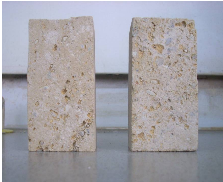
Fig. 6.29 - Provini di TGN trattati con una miscela di T-CON + T-VIN alla fine del test di cristallizzazione dei sali marini (dopo XV cicli).
