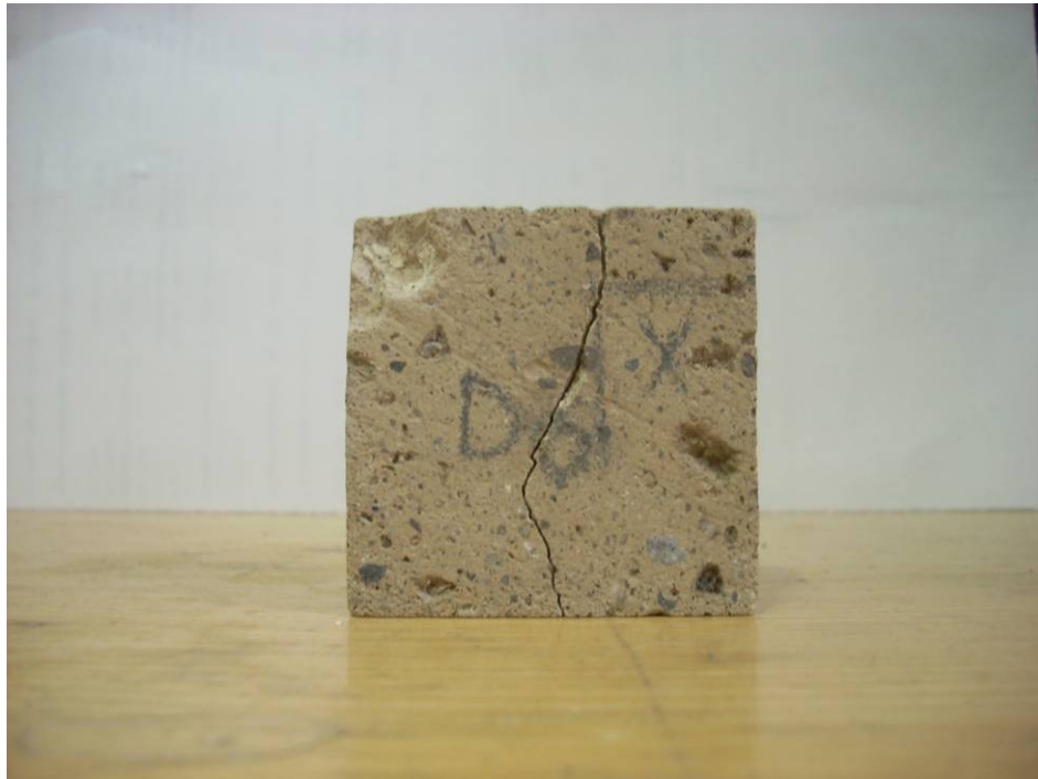
Fig. 6.22 - Presenza di fratture dopo il test secco-umido per un campione di IC gi trattato con consolidante T-CON.
