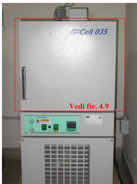
Fig. 4.20 - Apparecchiatura per la determinazione del coefficiente di dilatazione lineare termica.
