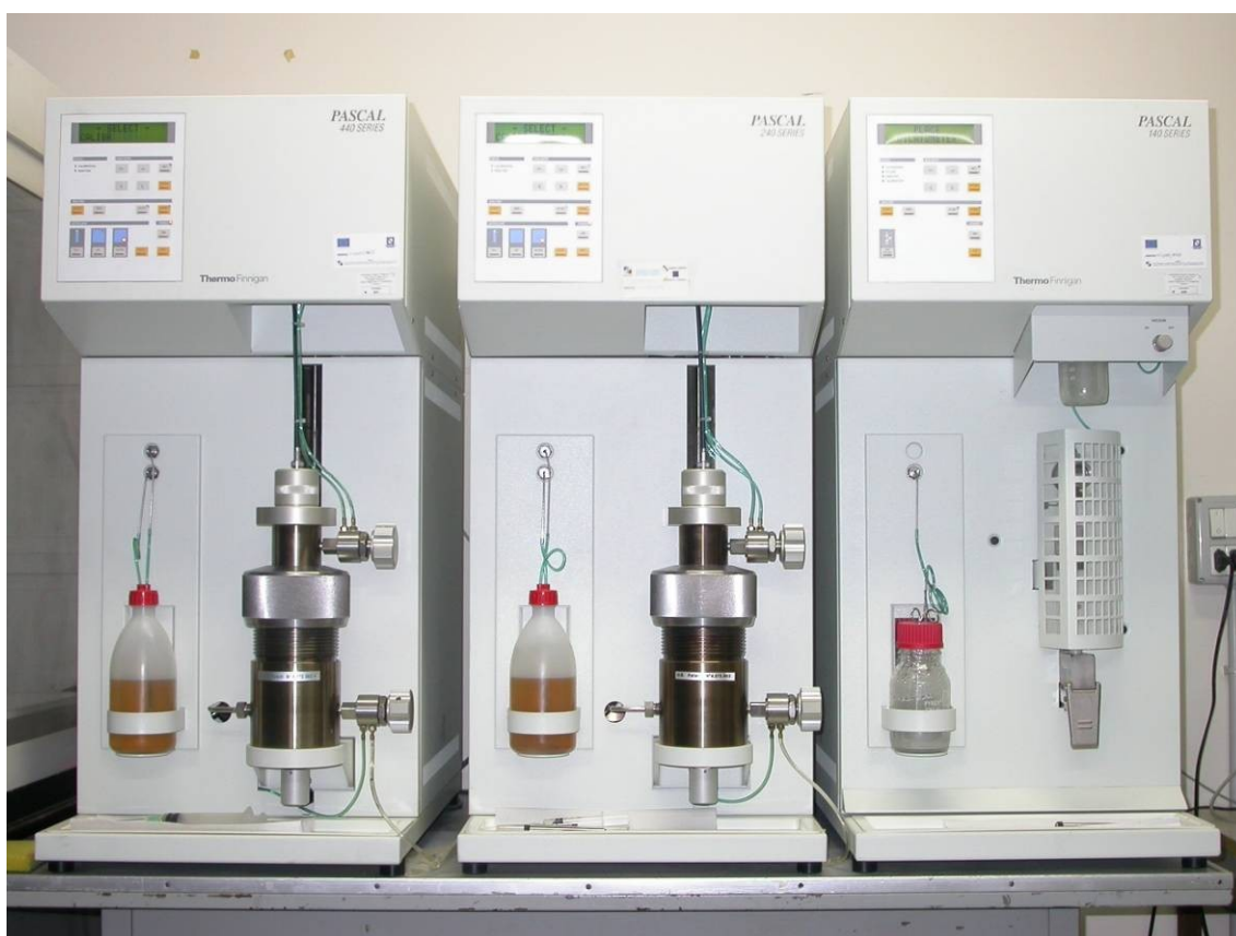
Fig. 4.24 - Porosimetro a mercurio Thermo Finnigan della serie Pascal (140, 240 e 440).
