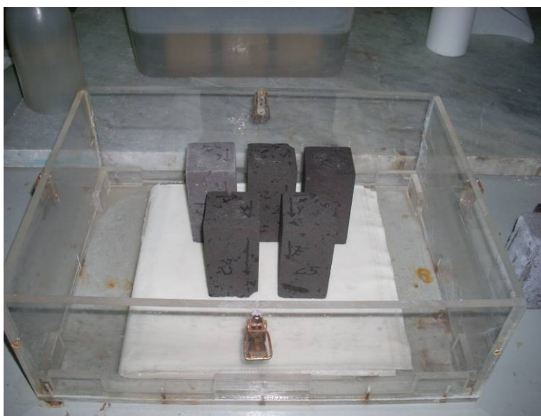
Fig. 4.17 - Provini di tufo adagiati su supporto poroso costituito da carta da filtro durante l'esecuzione della prova di risalita capillare eseguita sulla base delle indicazioni proposte dalla norma NORMAL 11/1985.
