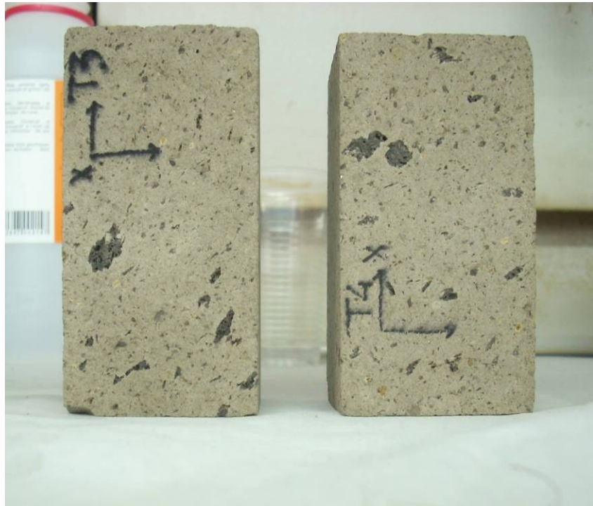
Fig. 6.28 - Provini di IC gr trattati con T-VIN alla fine del test di cristallizzazione dei sali marini (dopo XV cicli).
