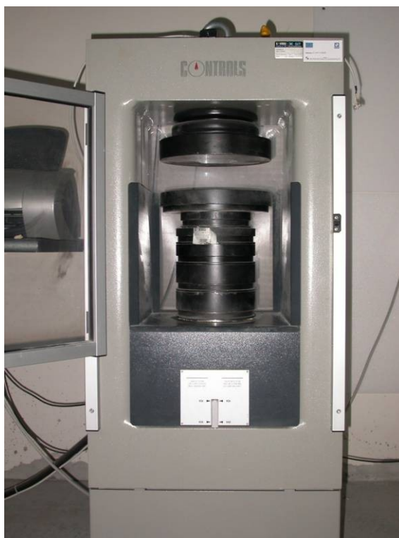
Fig. 4.18 - Telaio Controls 5600 utilizzato per la prova a compressione uniassiale semplice.
