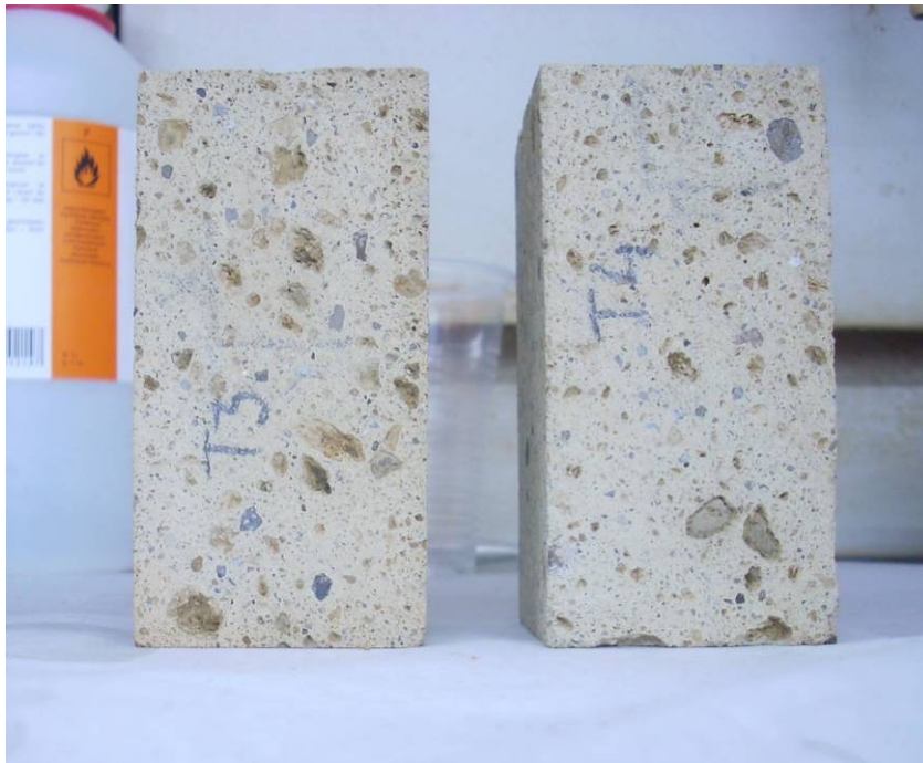
Fig. 6.27 - Provini di IC g trattati con T-VIN alla fine del test di cristallizzazione dei sali marini (dopo XV cicli).
