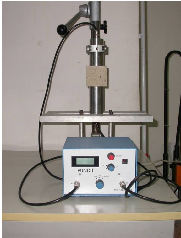
Fig. 4.19 - Apparecchiatura per la determinazione della velocità di propagazione del suono.
