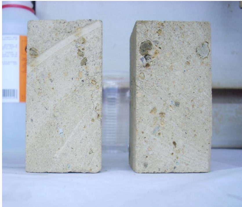
Fig. 6.26 - Provini di TGN trattati con T-VIN alla fine del test di cristallizzazione dei sali marini (dopo XV cicli).
