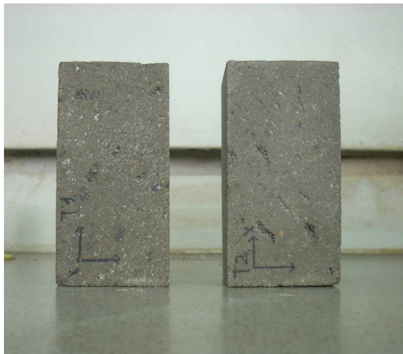
Fig. 6.25 - Provini di IC_{gr} trattati con T-CON alla fine del test di cristallizzazione dei sali marini (dopo XV cicli).
