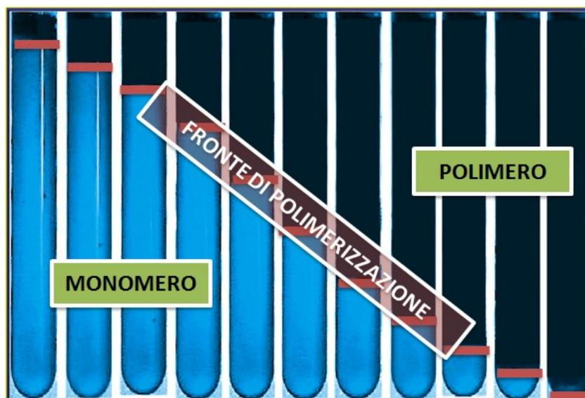
Figura III.1. Sequenza temporale dell'autopropagazione del fronte in un esperimento FP.
