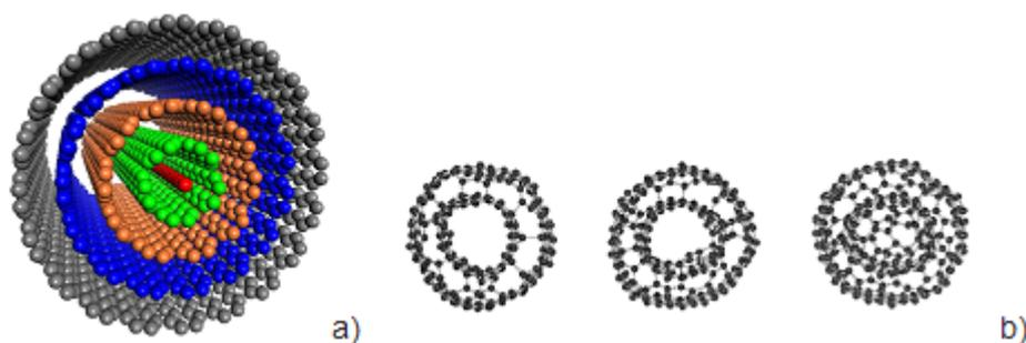
Figura II.7. Struttura di un MWNT (a) ed esempi di MWNT con *lip-lip interaction* (b).
