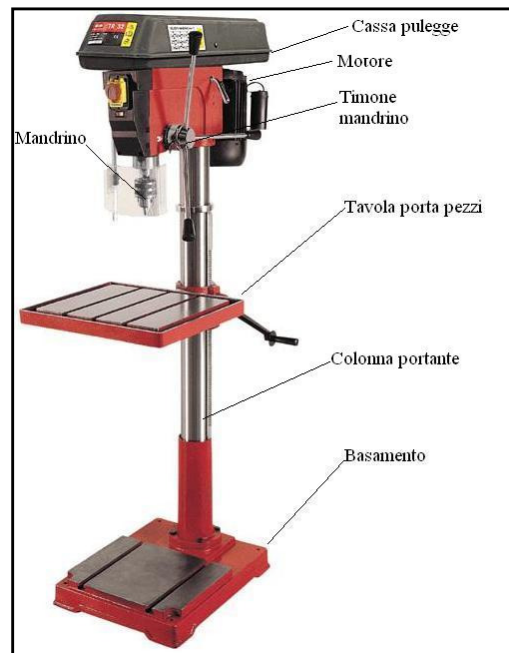
Figura 4.13 – Trapano a colonna per ottenere provini cilindrici utilizzati per le misure di porosità aperta.
