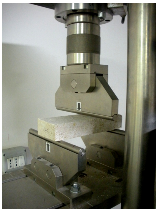
Figura 4.24 – Telaio Controls 65-L 1300 utilizzata per la prova di resistenza a flessione sotto carico concentrato.
