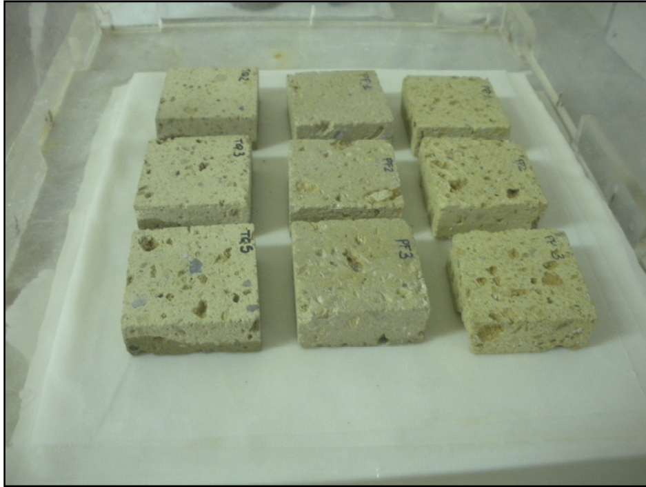
Figura 4.18 – Campioni di TGN tal quale e trattati, posti su supporti di carta filtro durante la prova di risalita capillare.
