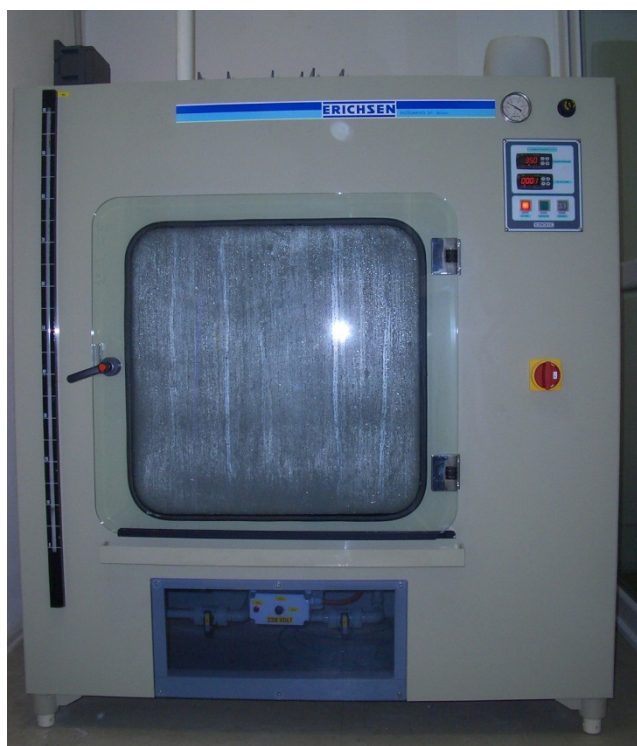
Figura 4.26 – Camera Corrotherm 610 (400 litri), ERICHSEN, per prove di corrosione in nebbia salina.
