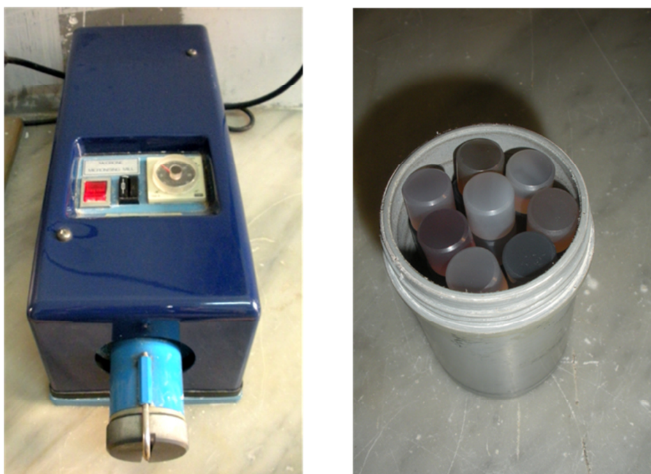
Figura 4.5 – Micronizzatore Mc Crone "Micronising Mill" (a sinistra) e cilindri d'agata (a destra).
