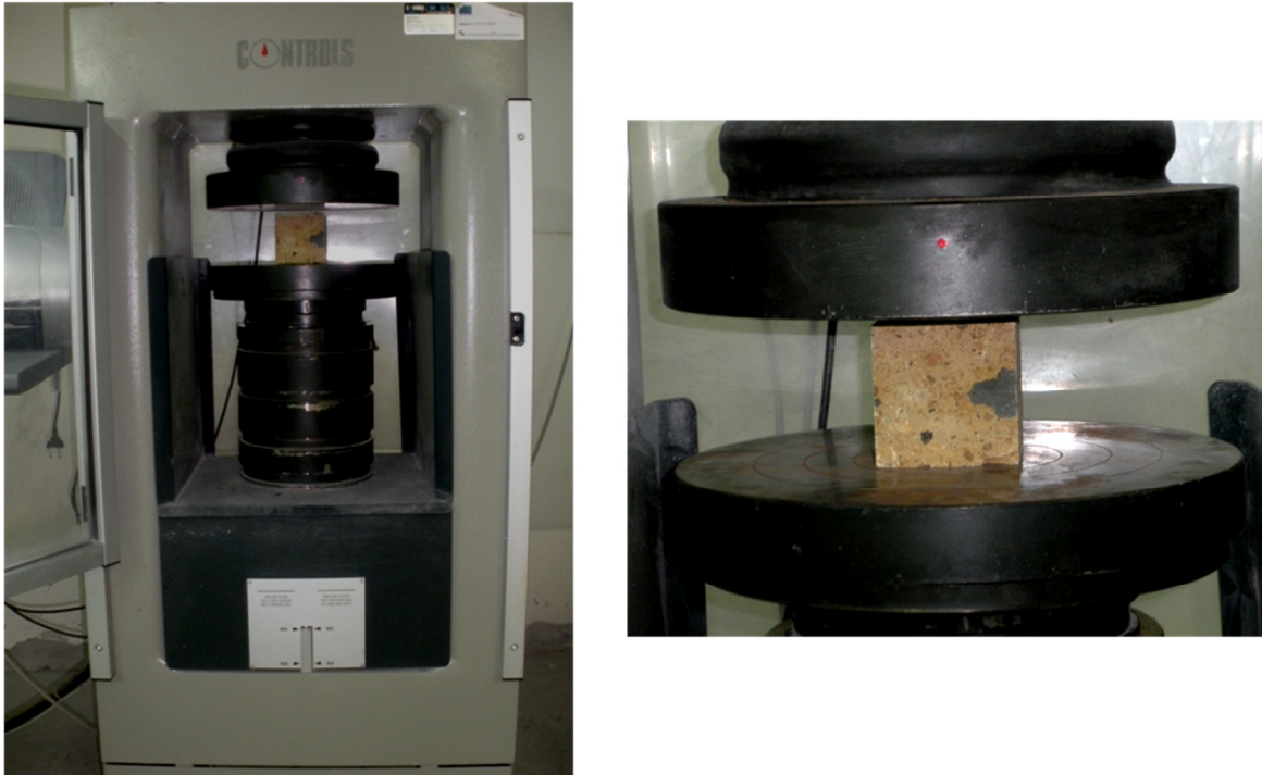
Figura 4.23 – Telaio Controls C5600 utilizzato per la prova a compressione uniassiale semplice (a sinistra) e particolare della pressa (a destra).
