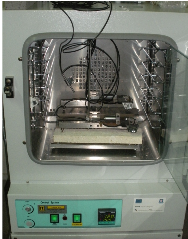
Figura 4.21 –Apparecchiatura per la determinazione del coefficiente di dilatazione lineare termica.
