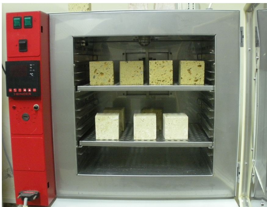
Figura 4 25 – Camera climatica Binder MK 53 per la prova di gelo-disgelo.
