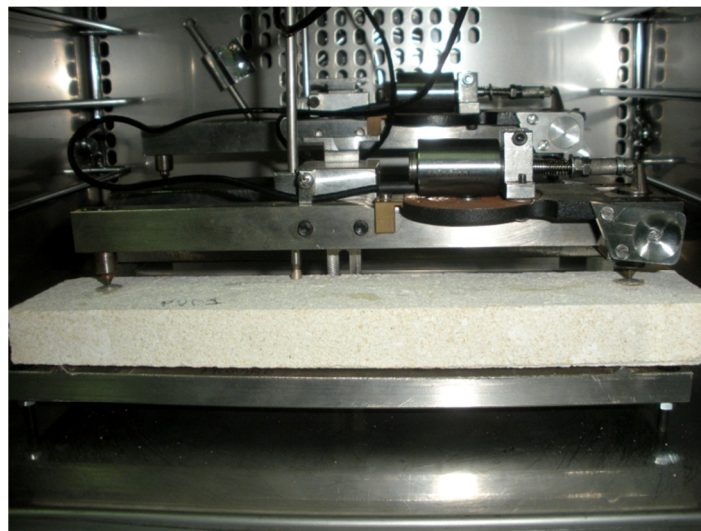
Figura 4.22 – Interno della cella: dettaglio dei dispositivi di misura (punte) del coefficiente di dilatazione termica in contatto col campione.
