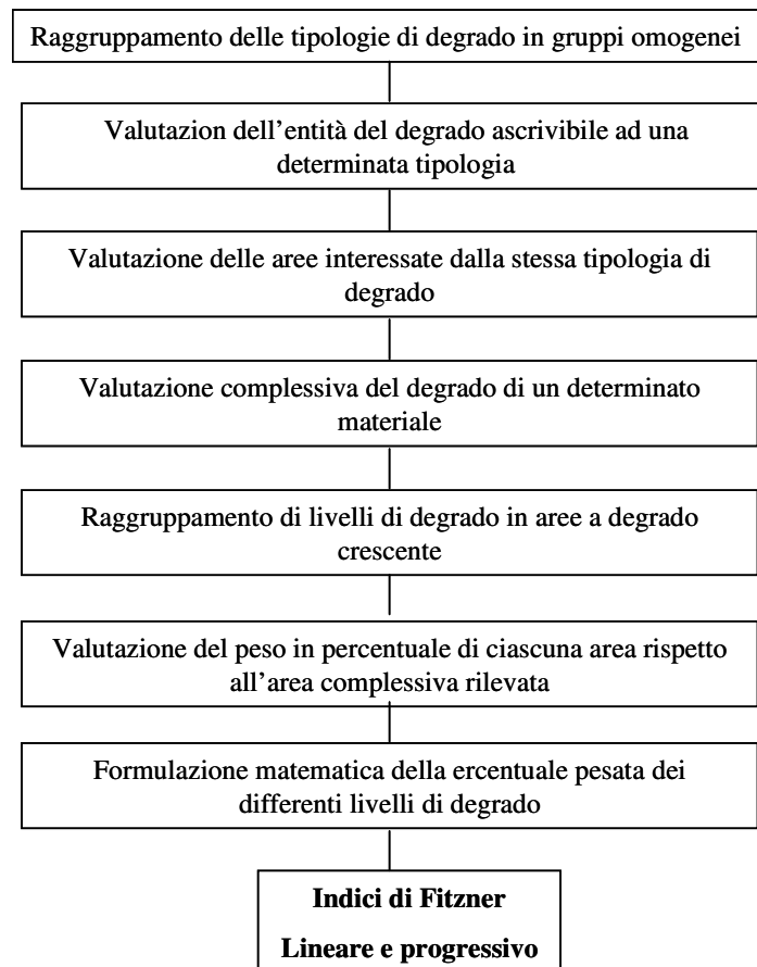
Figura 2.12 – Successione delle fasi di analisi di degrado secondo il metodo Fitzner & Heinrichs.
