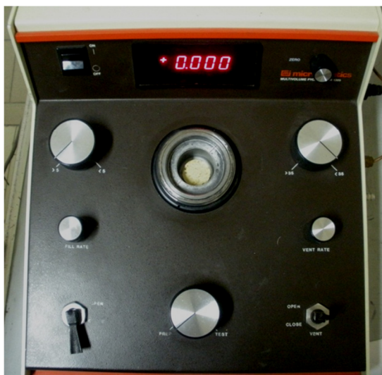
Figura 4.14 – Picnometro ad elio Micromeritics 1305 utilizzato per la determinazione della porosità aperta.
