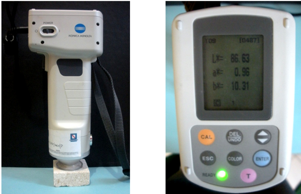
Figura 4.28 – Colorimetro Konica Minolta CR-400 (a sinistra) e particolare dello schermo (a destra).
