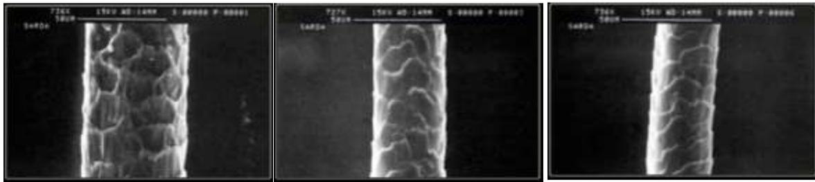
Figura 4. Caratterizzazione morfologica e strutturale della fibra di lana di razza Sarda al SEM
