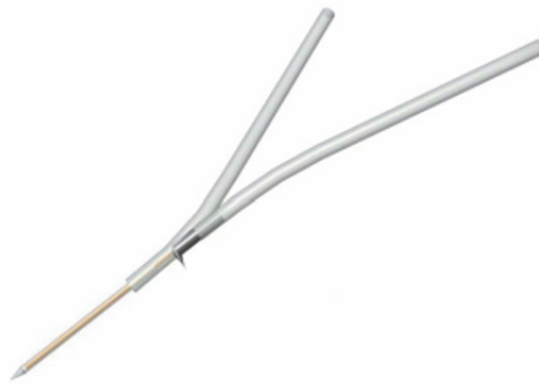
Figura 5. Rappresentazione tridimensionale della sonda da microdialisi a geometria coassiale utilizzata nel presente studio.
