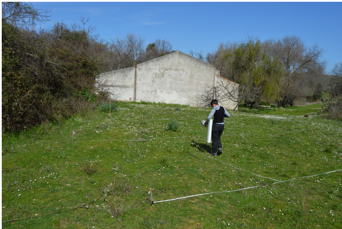
Fig. 8. Santa Giusta de Sas Abbas (Chiaramonti-SS). Presa dei punti lungo linee di percorrenza parallela in griglie di 10x10 m con intervallo di 0,50x1,00 m.
