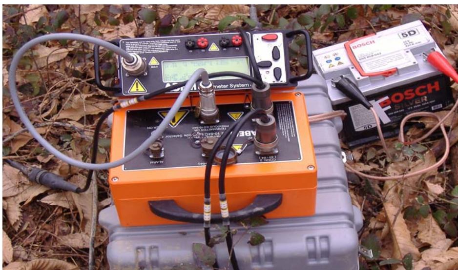
Fig. 5.19: Terrameter SAS 1000 con il LUND Imaging System e la batteria per l'alimentazione degli elettrodi.
