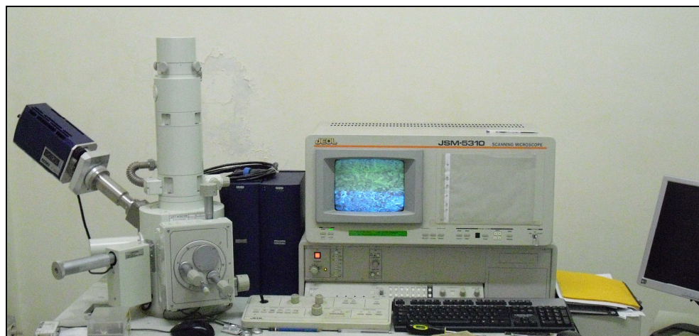
Figura 3.11 - Jeol JSM 5310 e Oxford INCA.
