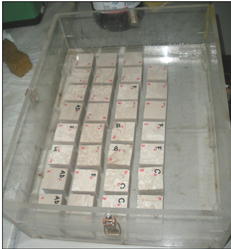
Figura 3.40- Campioni di CBL immersi nella soluzione salina.
