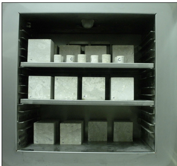
Figura 3.41 – Provini di CBL all'interno della camera climatica.
