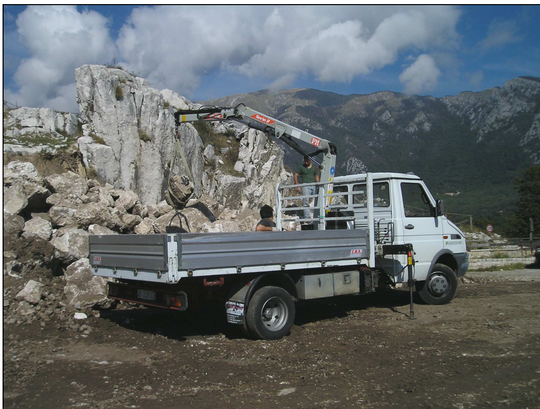
Figura 3.1 – Campionamento blocchi di roccia (Cava Canale – Pietraroja – BN).
