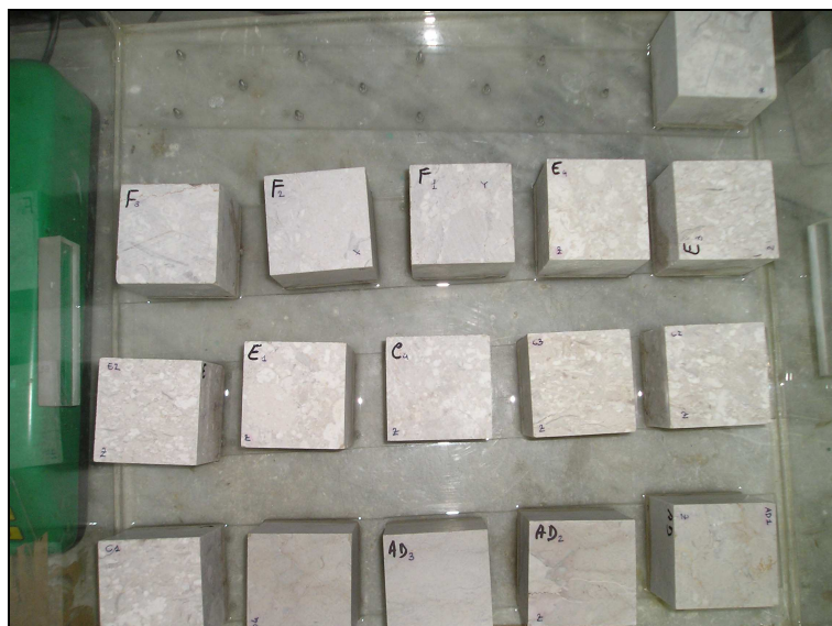
Figura 3.22 - Provini di CBL adagiati su supporti durante l'esecuzione della prova di risalita capillare eseguita sulla base delle indicazioni proposte dalla norma UNI EN 1925.
