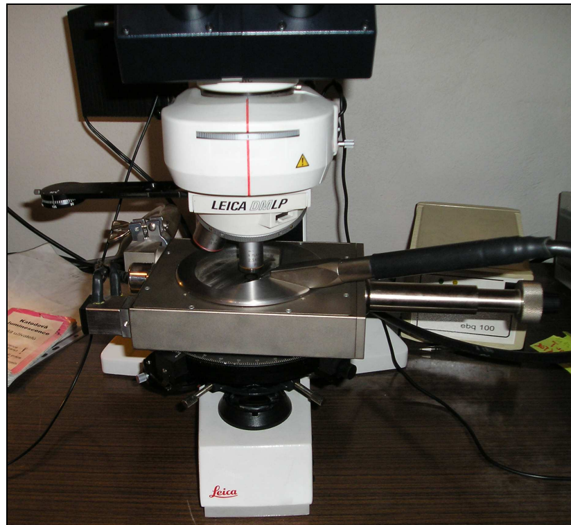
Figura 3.8 - Dettaglio della camera a vuoto.
