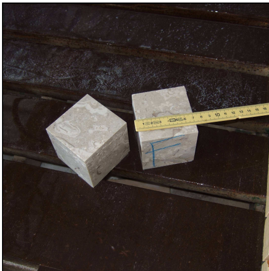
Figura 3.2 – Fasi di lavorazione dei campioni. a) taglio dei blocchi di roccia con sega a getto d’acqua; b) sagomatura dei campioni con sega circolare; c) Lucidatura delle lastre; d) foggatura dei provini cilindrici con minicarotiere; e) campioni cubici finiti; f) campioni cilindrici finiti.
