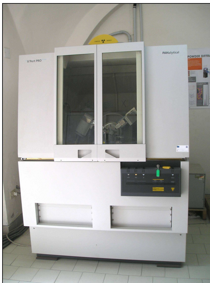
Figura 3.13 - Diffrattometro Panalytical X'Pert PRO.
