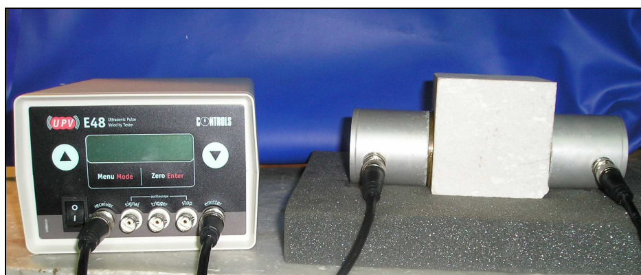
Figura 3.24 - Apparecchiatura per la determinazione della velocità di propagazione del suono.
