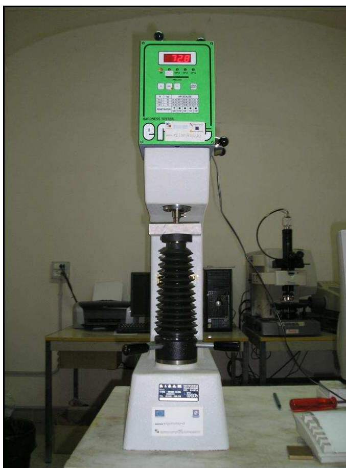
Figura 3.37 - Apparecchiatura Ernst NR3 DSR.
