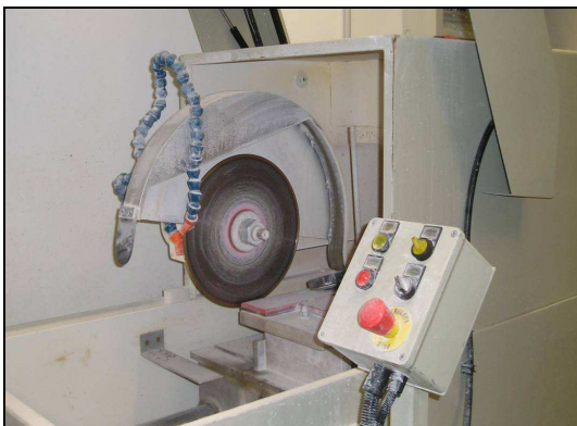
Figura 3.3 - Tagliatrice a disco diamantato
