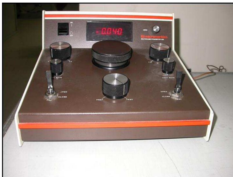
Figura 3.21 - Picnometro ad elio Micromeritics 1305.
