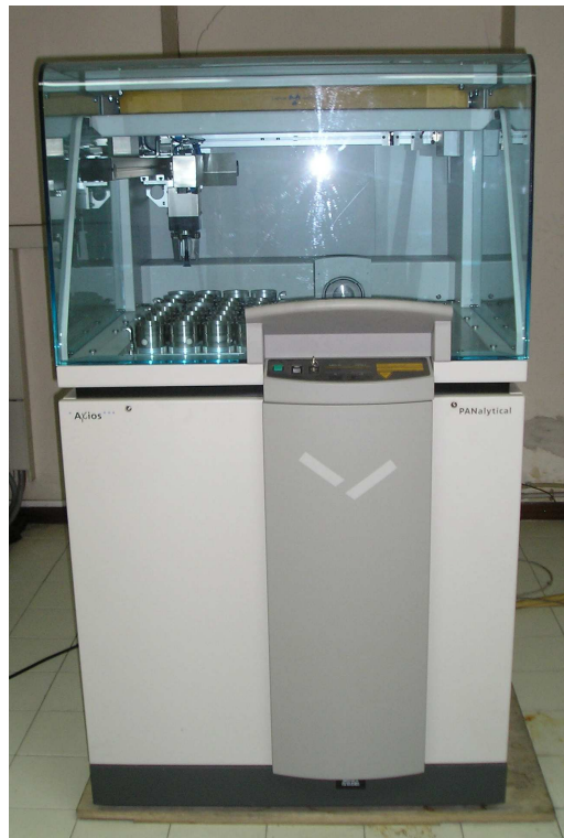
Figura 3.16 – Spettrometro automatico Panalytical Axios.
