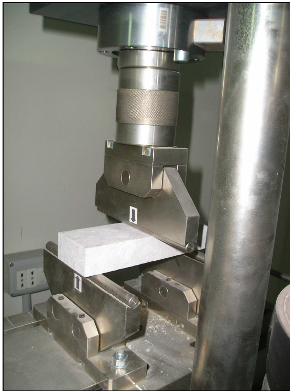
Figura 3.32 - Dettaglio della macchina Controls 65-L 1300 raffigurante i coltelli d'appoggio ed il coltello di carico.
