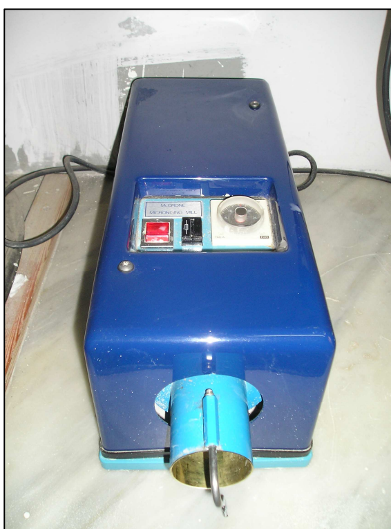
Figura 3.12 - Micronizzatore McCrone "Micronising Mill".
