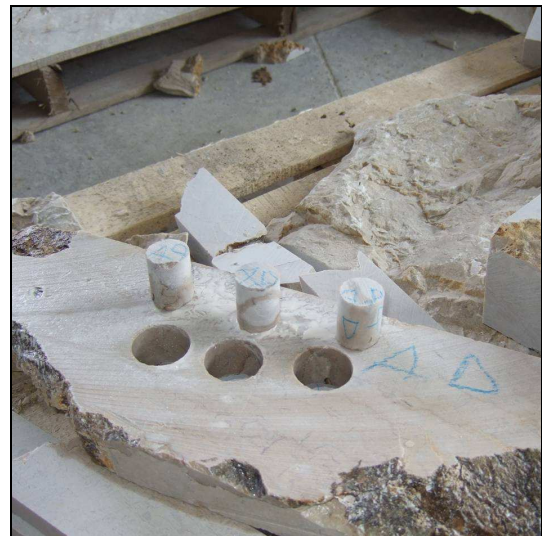
Figura 3.2 – Fasi di lavorazione dei campioni. a) taglio dei blocchi di roccia con sega a getto d’acqua; b) sagomatura dei campioni con sega circolare; c) Lucidatura delle lastre; d) foggatura dei provini cilindrici con minicarotiere; e) campioni cubici finiti; f) campioni cilindrici finiti.
