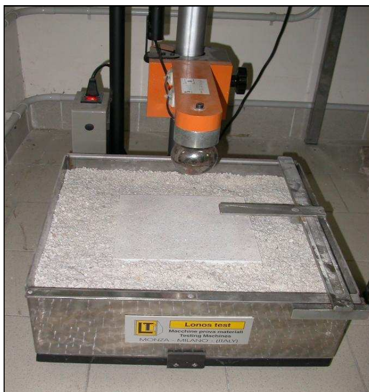
Figura 3.35 - Apparecchiatura per la determinazione della resistenza all'urto.
