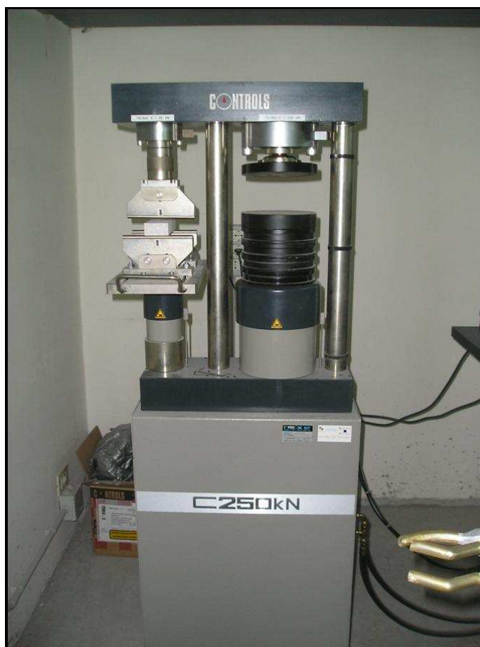
Figura 3.31 - Macchina Controls 65-L 1300 utilizzato per la prova di resistenza a flessione sotto carico concentrato.
