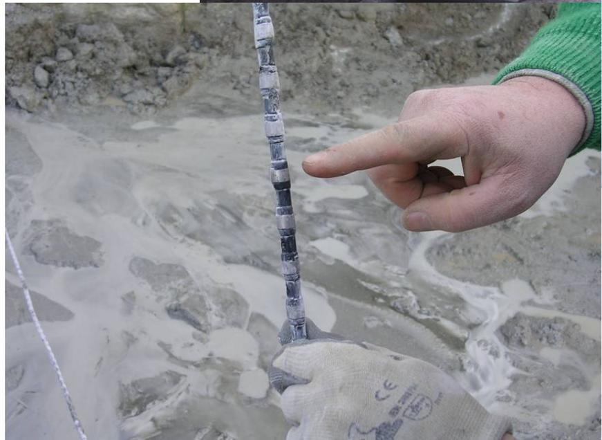
**Figura 3-32 Particolare del filo diamantato.**
