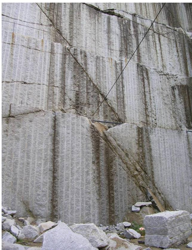
**Figura 3-19** Fronte di cava interessato da fratturazione pervasiva.
