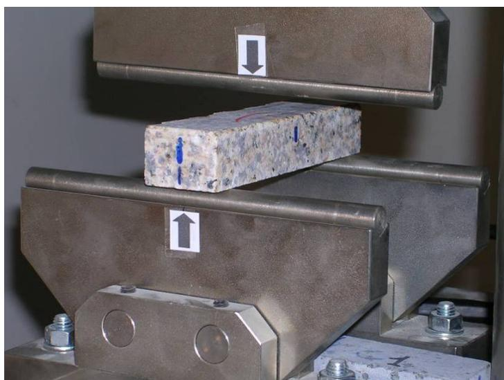
**Figura 4-4** Lastrina sulla pressa per la determinazione della resistenza a flessione.
