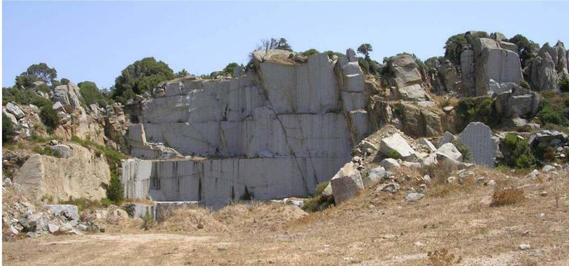
**Figura 6-63 Fronte della Cava Inginocchiaddu. Si noti il sistema di fratturazione.**
