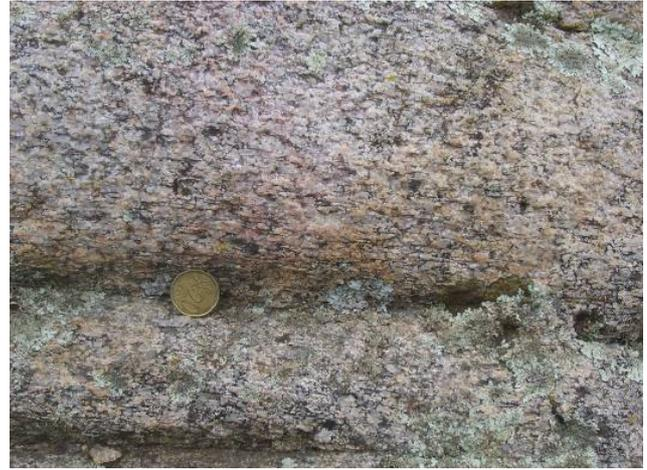
**Figura 6-4** Microfratturazione tipica del granito Giallo San Giacomo.
