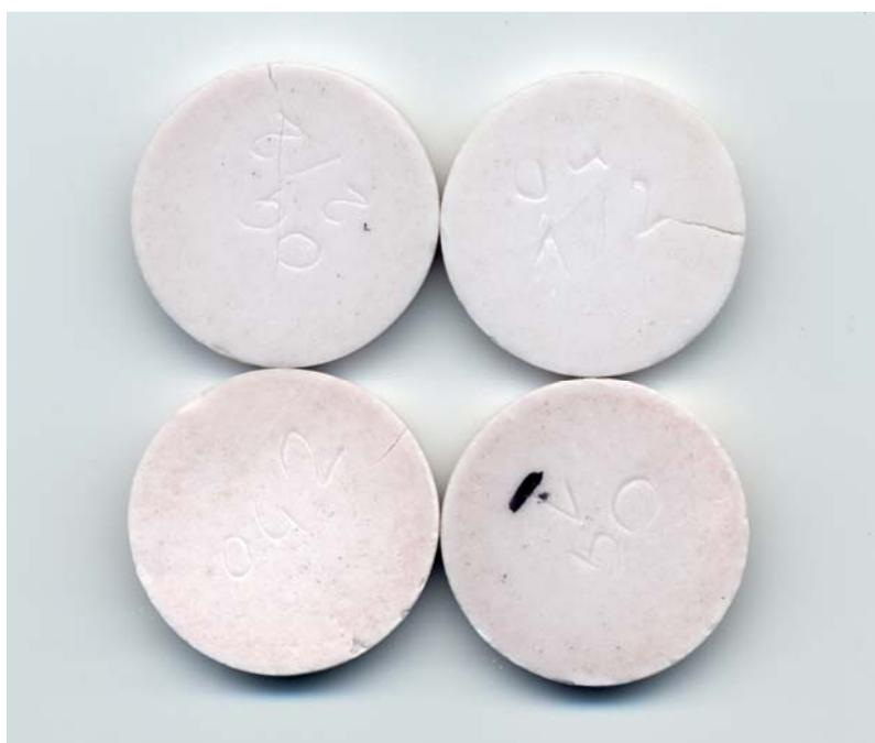
**Figura 10-1** Cialde ottenute dai campioni OG1 e OG2. In basso cialde ottenute dalle polveri tal quali, in alto cialde ottenute dalle polvere deferritizzate.
