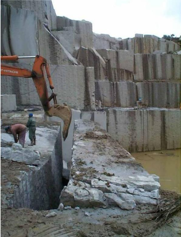
**Figura 3-24** Ribaltamento di una bancata tramite la spinta di una pala meccanica.
