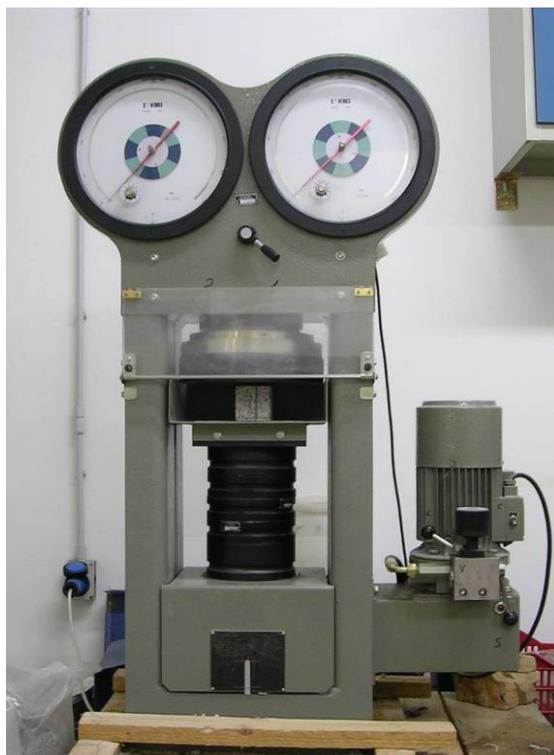
**Figura 4-3 Pressa per la determinazione della resistenza a compressione semplice.**
