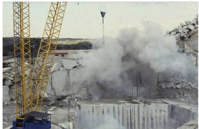
**Figura 3-29** Volata per il taglio primario di una bancata di grandi dimensioni.
