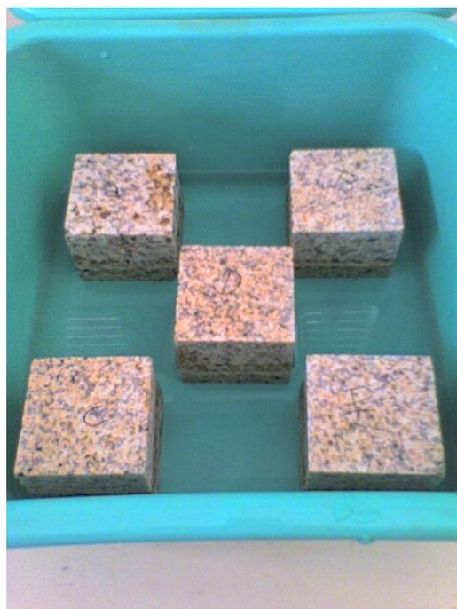
**Figura 4-2** Cubetti di Giallo San Giacomo durante la prova di determinazione dell'assorbimento d'acqua per capillarità.
