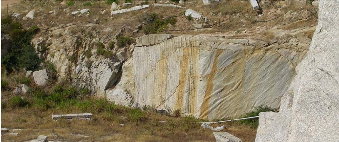
Figura 6-58 Taglio effettuato con il *Flame – jet*.
