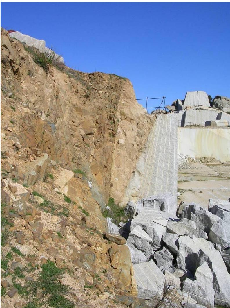
**Figura 6-72** Avanzata del fronte arrestata in prossimità di un filone basico.
