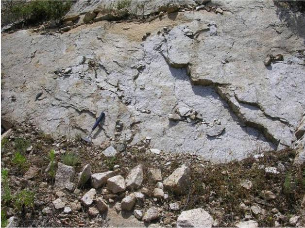
**Figura 6-3** Microfratturazione tipica del granito Giallo San Giacomo.
