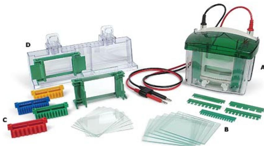
Figura 33: Apparato per l'elettroforesi monodimensionale (MiniProtean Tetra Cell, BioRad).
