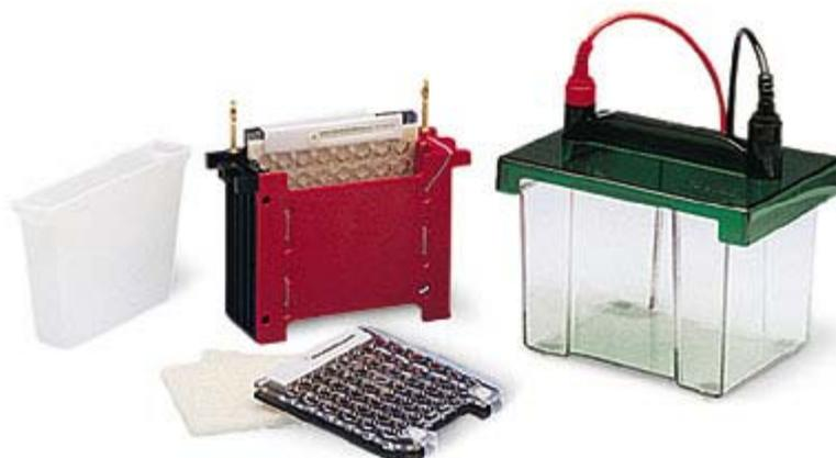
Figura 34: Apparato per l'immunoblotting (Mini TransBlot Cell, BioRad).
