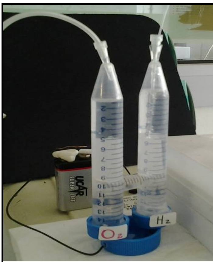
Fig.6 elettrolizzatore costruito nel laboratorio di elettrochimica di Timisoara
