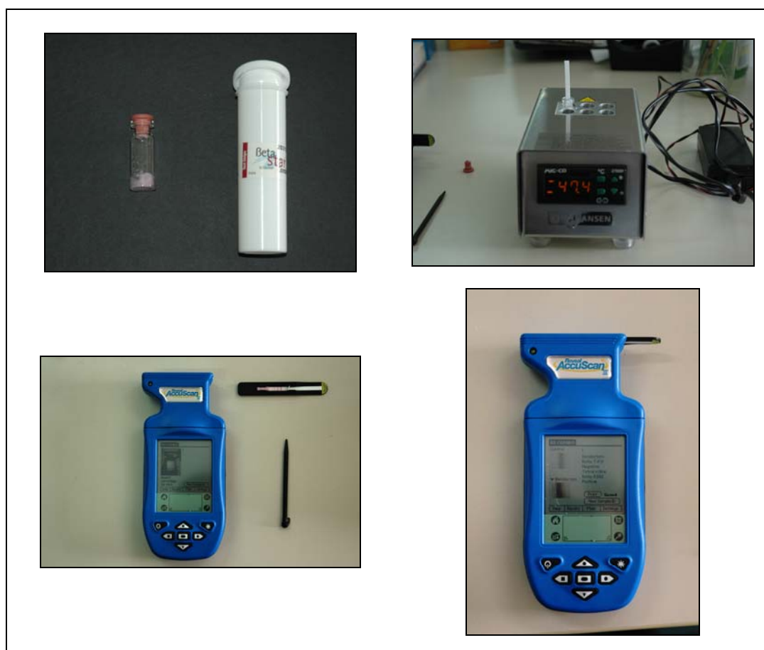
Figura 9. Dall'alto e da sinistra: boccetta contenente i reagenti e contenitore con cartine ( dipsticks ); incubazione a temperatura controllata; sistema di lettura Accuscan III; lettura con Accuscan III.
