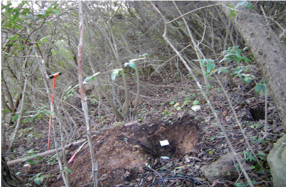
Figura 4a. Strumento TDR nel versante sotto la macchia.
