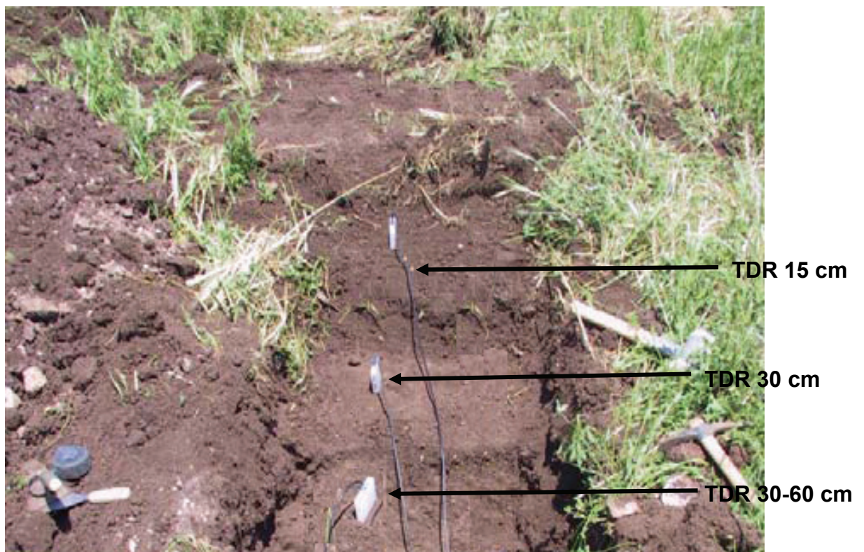
Figura 4b: Installazione sonde TDR nel versante a pascolo alle diverse profondità.
