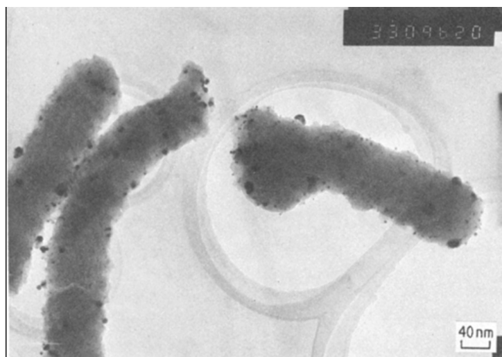
Figura 1.23 – Immagine TEM del P3MT-CF 3 SO 3 - , elettropolimerizzato su Pt in CH 3 CN, ad un livello di doping del 30%: struttura fibrillare con cristalliti.
