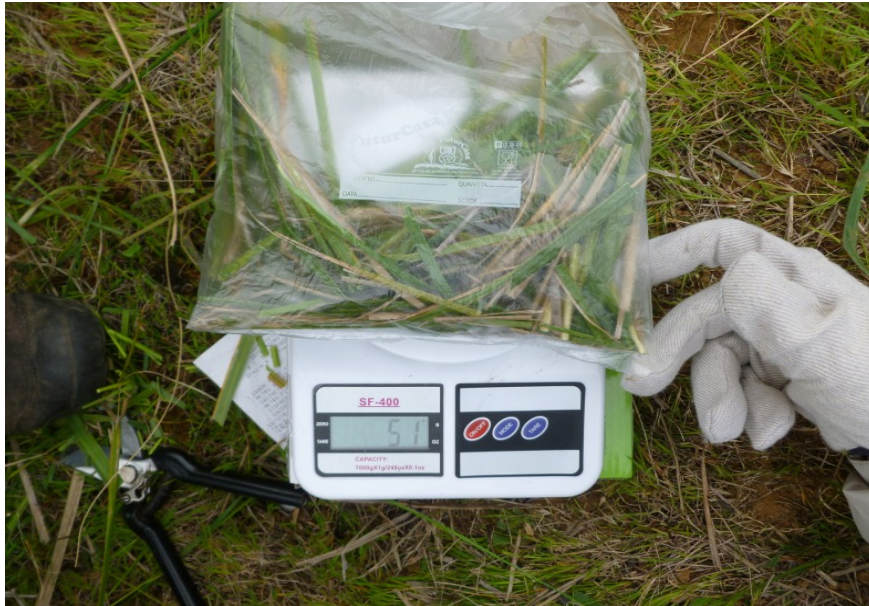
Figura 55: Pesatura in campo dei campioni
