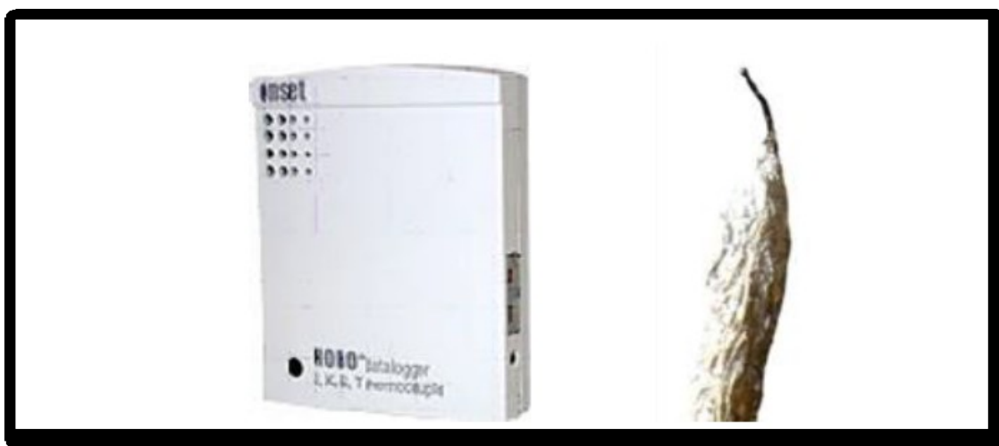
Figura 25: Datalogger Hobo Onset e Termocoppia di tipo K.
