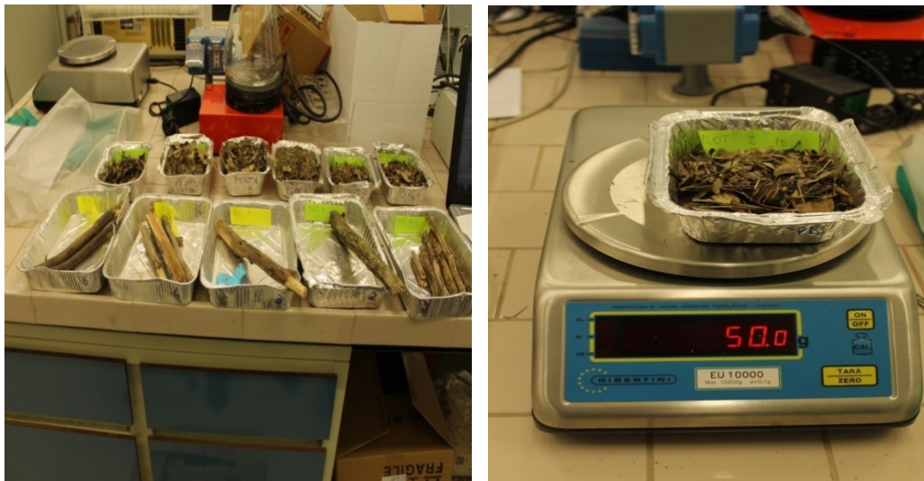
Figura 18: Pesatura dei campioni prima dell'essiccazione
