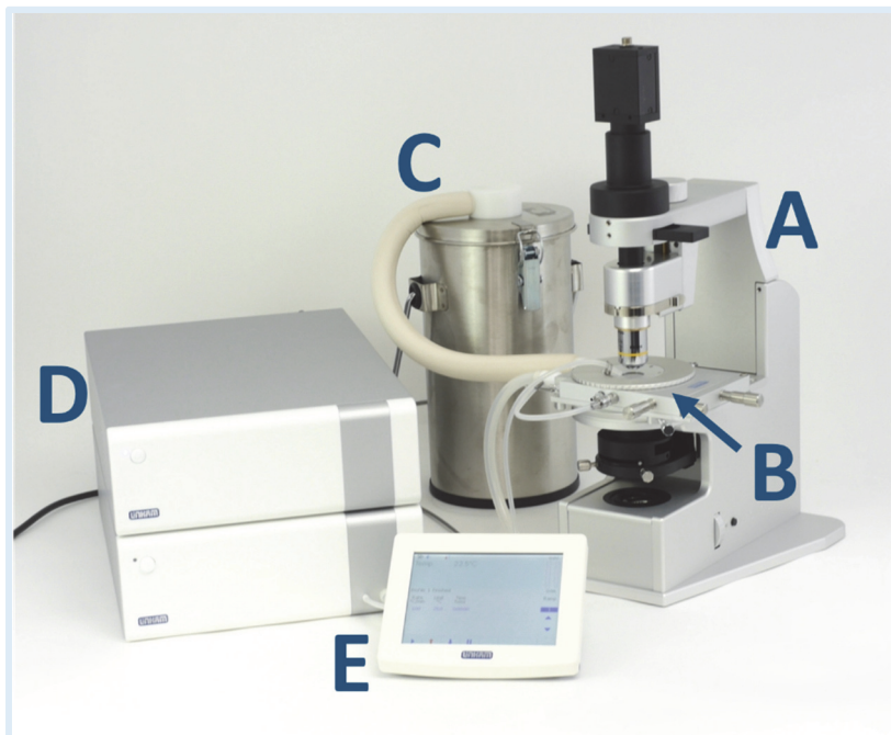
Figura 3.1: Sistema di criomicroscopia costituito da: stazione d'immagine (A), stage BCS196 (B), serbatoio per azoto liquido (C), sistema di controllo automatizzato della temperatura PE95/T95 (D), interfaccia di controllo touch-screen (E).
