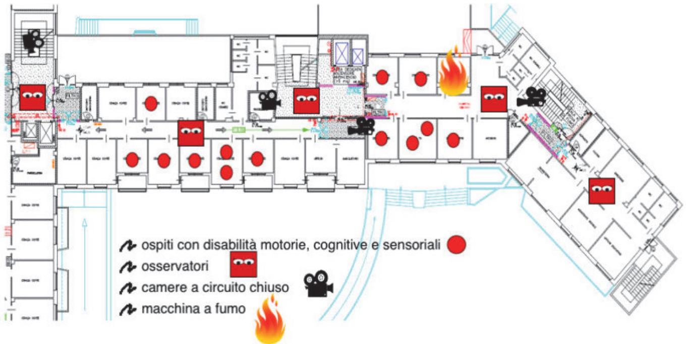
(a) Lo scenario della simulazione: Primo piano di Casa Serena ore 9 del mattino. riproduzione di un incendio in una stanza mediante macchina a fumo
