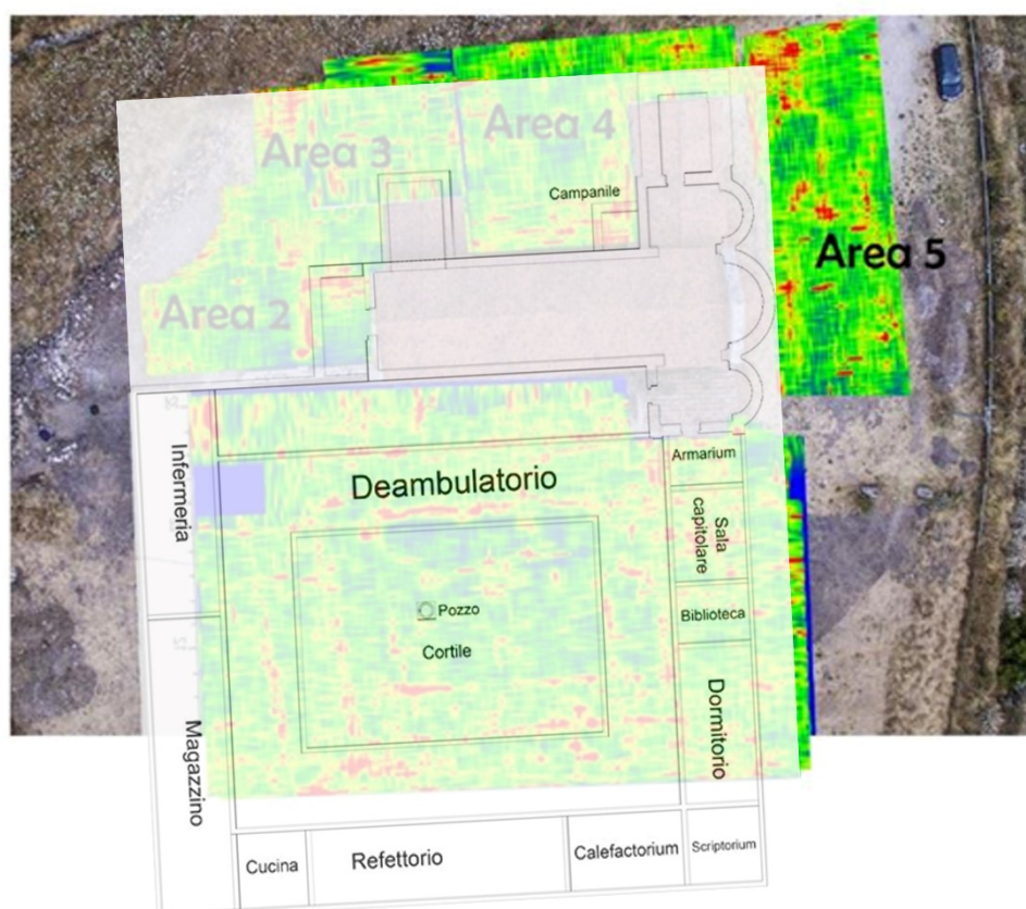
Fig. 90. Ricostruzione planimetrica sulla base dei rilievi geofisici
