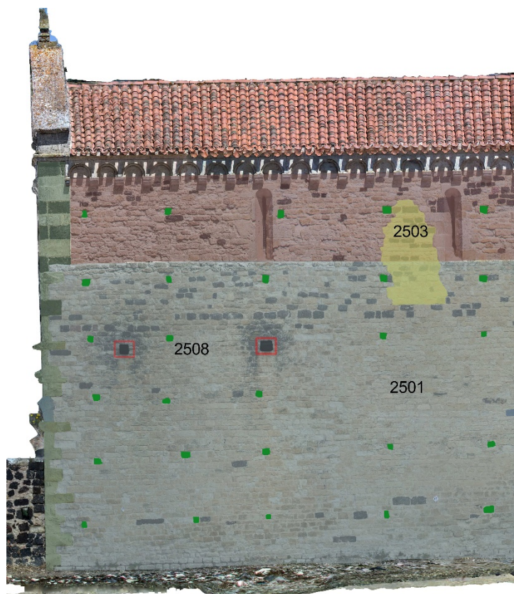
Fig. 77. Una porzione del prospetto meridionale della chiesa con l'indicazione di alcune USM
