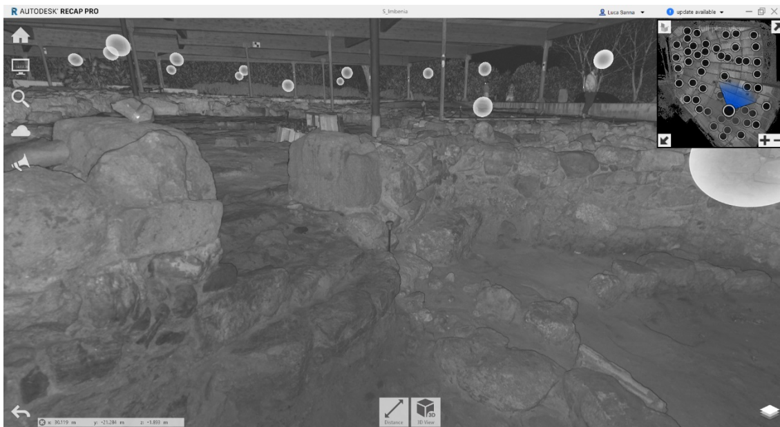
Fig. 37. Il rilievo effettuato mediante laser scanner dopo la fase di allineamento. Visuale dall'ambiente 47.
