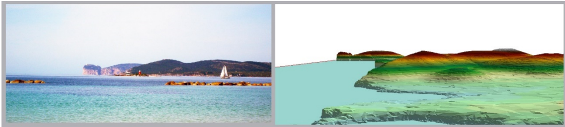
Fig. 29. Un'immagine di Capo caccia e la ricostruzione effettuata elaborando le DTM e convertendole in TIN
