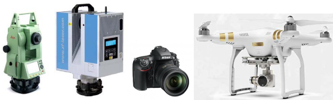
Fig. 6. Da sinistra a destra gli strumenti utilizzati per i rilievi 3D: la stazione totale, il laser scanner, la fotocamera e il drone, mediante i quali è stato possibile acquisire i dati metrici e fotogrammetrici dei siti in cui si è operato.
