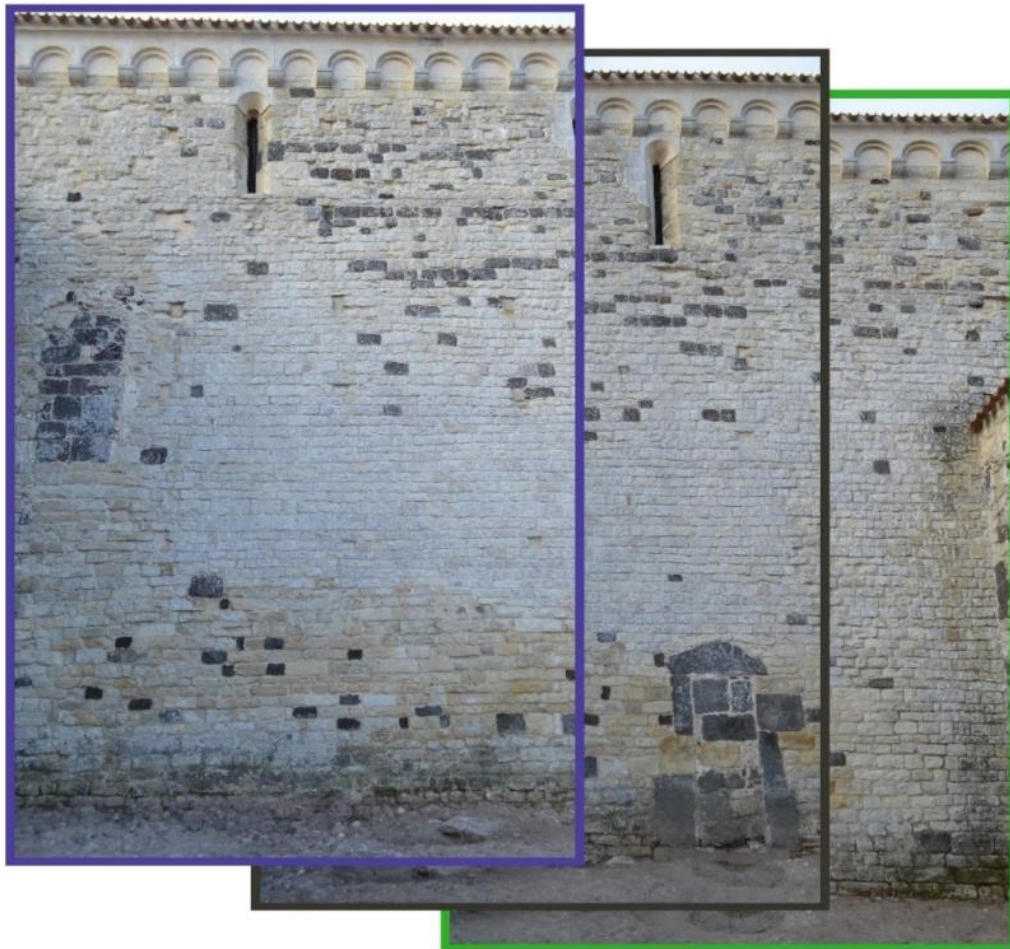
Fig. 17. Schema di sovrapposizione della sequenza di immagini per un rilievo fotogrammetrico con un buon livello di matching .
