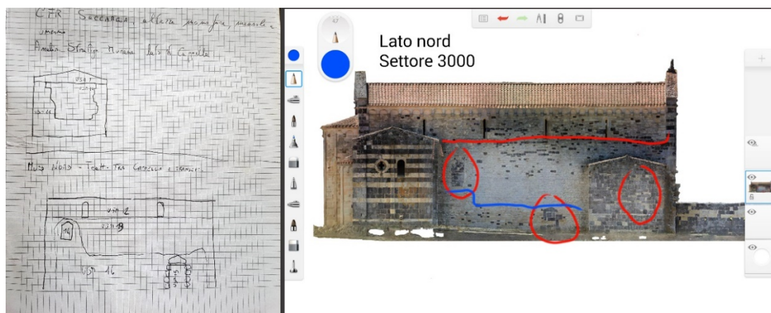
Fig. 97. Il primo eidotipo realizzato per l'analisi stratigrafica muraria e il successivo lavoro di identificazione delle USM su tablet con l'applicazione Autodesk SketchBook.
