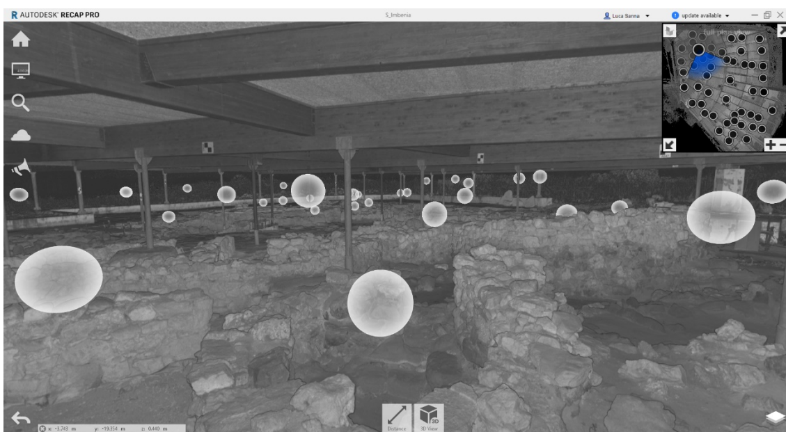
Fig. 38. Il rilievo effettuato mediante laser scanner dopo la fase di allineamento. Visuale generale.
