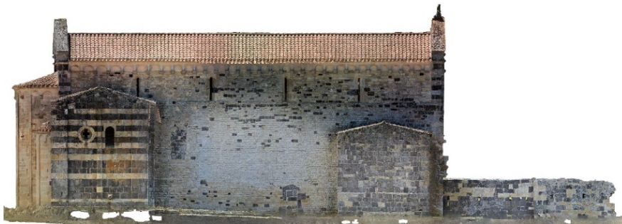
Figg. 92, 93. I prospetti occidentale, in alto, e orientale della chiesa elaborato con Photoscan.
