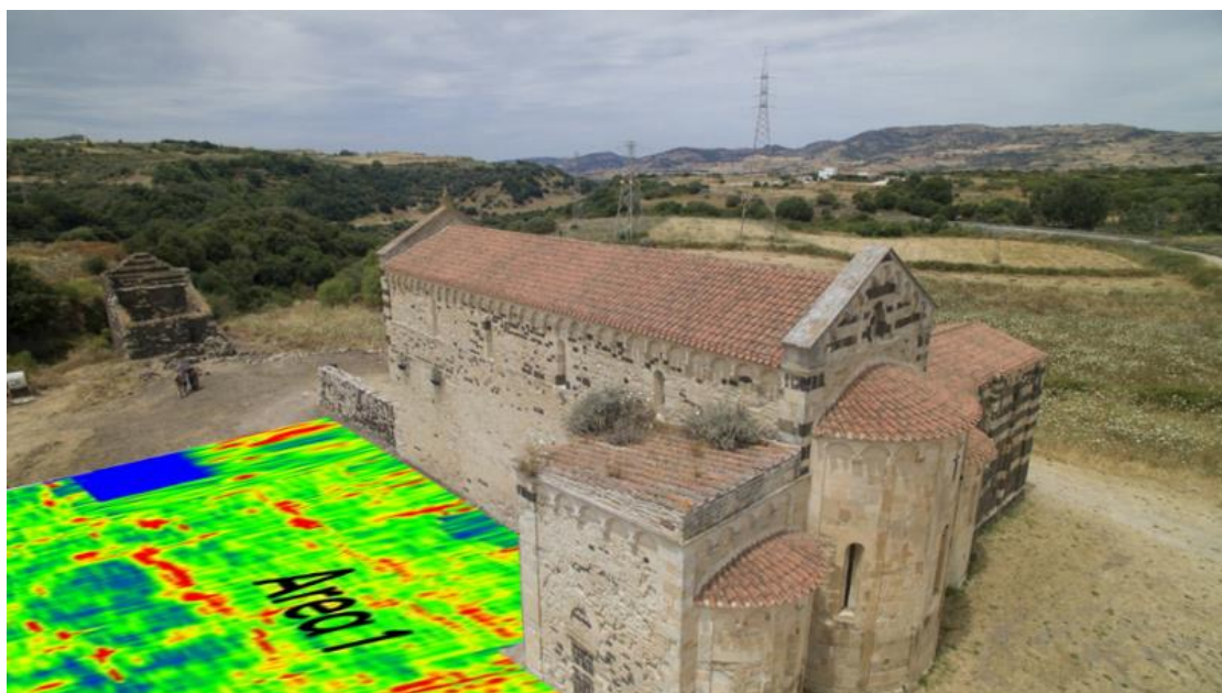
Fig. 89. Il risultato delle indagini georadar in rapporto alla chiesa (foto G. Saturno; elab. L. Sanna).
