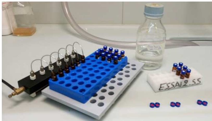
Figura 9. Evaporazione dei campioni filtrati con azoto gassoso 5.0 e risospesi in fase mobile (acetonitrile, acqua, acido acetico).
