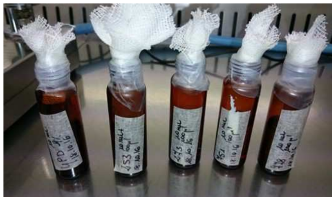
Figura 11. Semina dei lieviti su terreno YPD agar a becco di clarino in vials da 20 mL per l'analisi HS-SPME/GC-MS.
