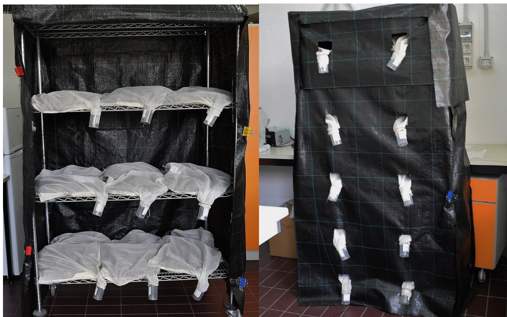
Figura 3 – Scaffale per lo stoccaggio delle galle in laboratorio: aperto per mostrare il suo interno (sn) e pronto all’uso (dx).
