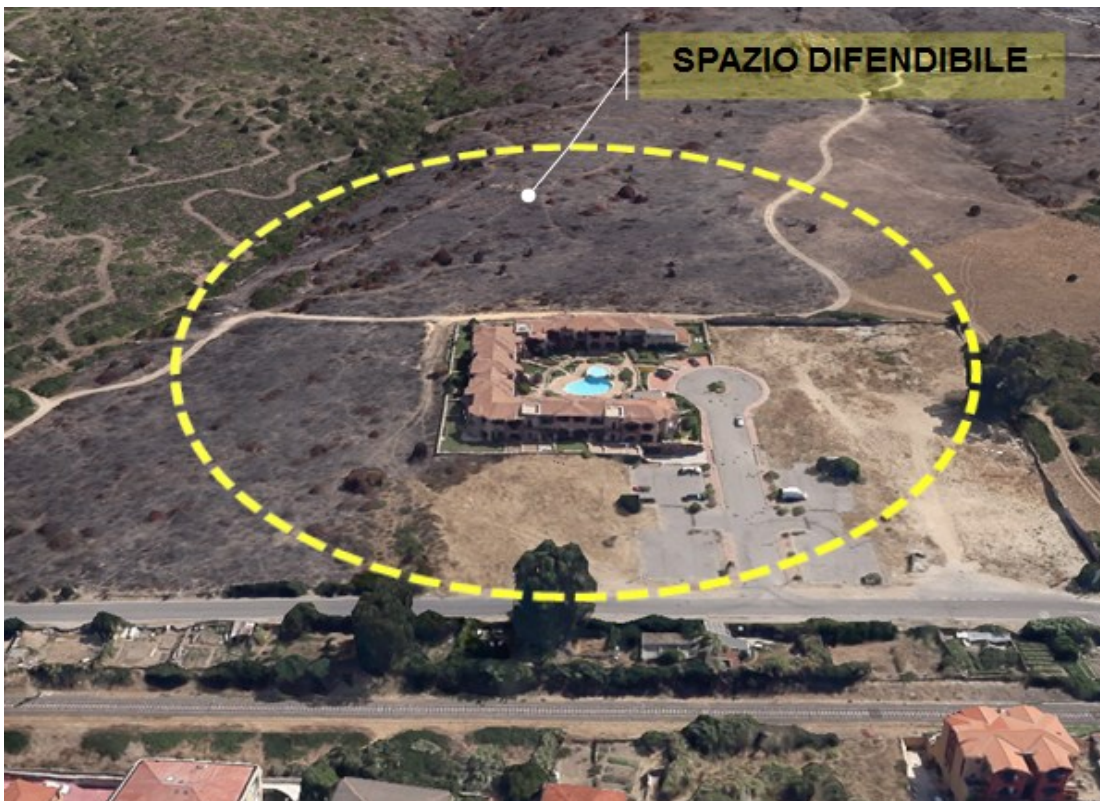
Figura 22. Esempio di spazio difendibile intorno ad una struttura ricettiva nel nord-est della Sardegna, dove malgrado la bassa vegetazione mediterranea, le fiamme sono riuscite a raggiungere il perimetro della struttura (Fonte CFVA).
