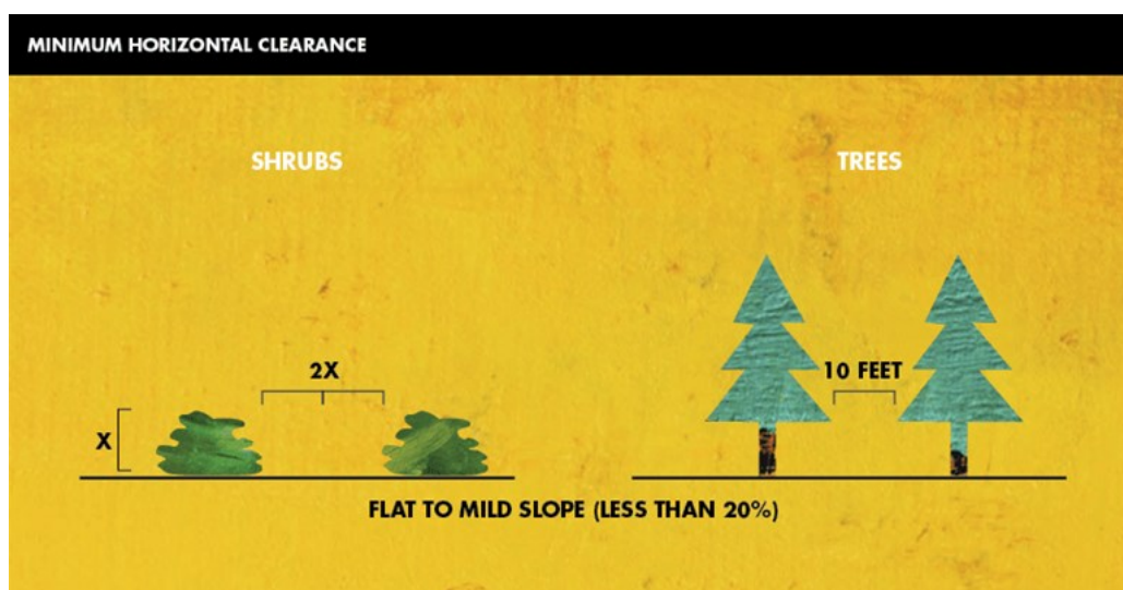
Figura 23. Prescrizioni tecniche per la disgiunzione delle chiome di alberi ed arbusti per la riduzione della continuità del combustibile (Immagine disponibile presso l'indirizzo internet https://www.readyforwildfire.org/prepare-for-wildfire/get-ready/defensible-space/ )
