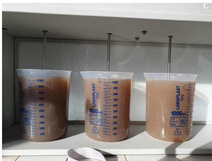
Figura 36: Esecuzione della prima parte del processo Fenton in piattaforma Jar-test
