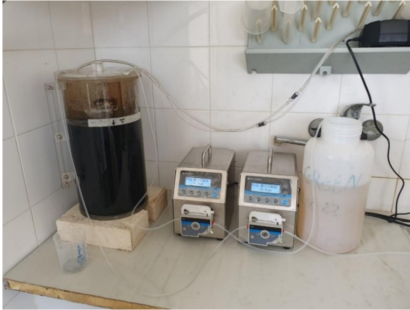
Figura 18: Reattore in plexiglass con sistema di aerazione e di dosaggio dell'alimentazione nella sua prima configurazione.
