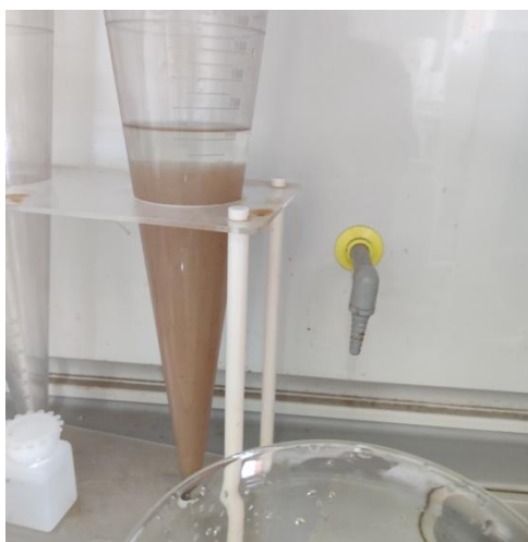
Figura 38: Sedimentazione in cono Imhoff: si evidenzia la separazione fango/refluo trattato
