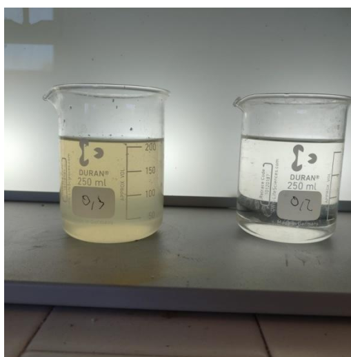
Figura 34: A sinistra il becher con il campione del refluo elastomeri pretrattato in ingresso ai filtri, a destra il becher con il campione del refluo elastomeri in uscita dalla filtrazione durante i primi giorni di trattamento della 1° Fase.
