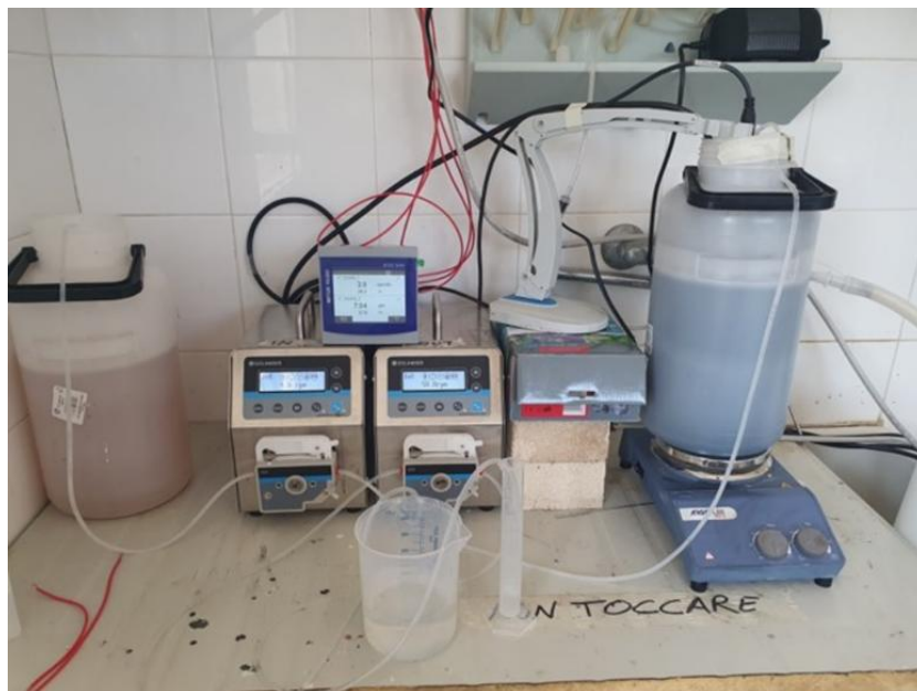
Figura 19: Reattore in PEAD nella sua seconda configurazione. Si può notare l'agitatore magnetico alla base del reattore, la sonda per la misura dell'ossigeno disciolto all'interno e la centralina della Mettler Toledo sopra le due pompe peristaltiche.
