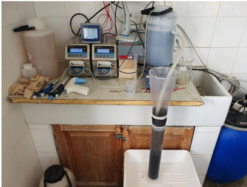
Figura 20: Reattore nell'ultima configurazione. Si può notare il sistema di recupero dei fanghi in uscita dal reattore.
