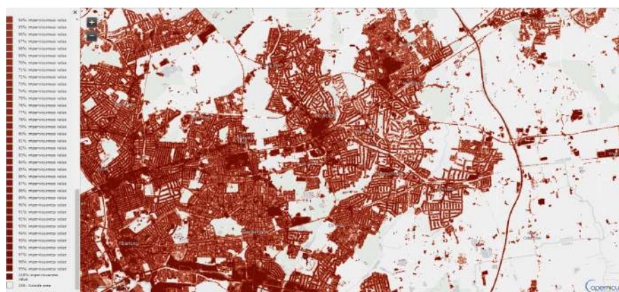
Figura 37: Web Service della componente Pan-Europea del Copernicus Land Service - HLR Imperviousness, nel particolare l'area geografica di East-London nel 2018, i diversi colori indicano i diversi livelli (espressi in percentuale) di impermeabilità del suolo. Immagine da https://land.copernicus.eu/pan-european/high-resolution-layers/imperviousness/status-maps/imperviousness-density-2018 .
