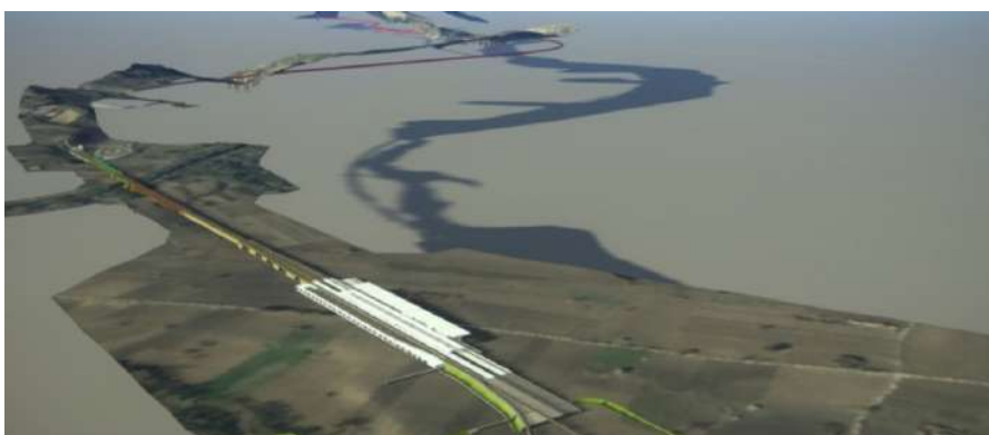
Figura 5: Immagine della modellazione del tratto ferroviario di circa 18 km ad alta velocità Apice-Hirpinia ( v > 200 \text{ km/h} ), nel quale il BIM è stato utilizzato per la progettazione dell'intero tracciato e non solo per opere puntuali. Immagine da https://www.italferr.it/content/italferr.it/innovazione/bim/infrastrutture-ferroviarie-di-linea.html .
