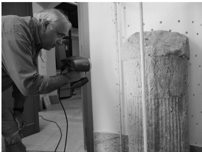
FIG. 3 Rilievo con laser scanner della colonna votiva a Hercules dedicata dai Martenses ( CIL x, 7858).
