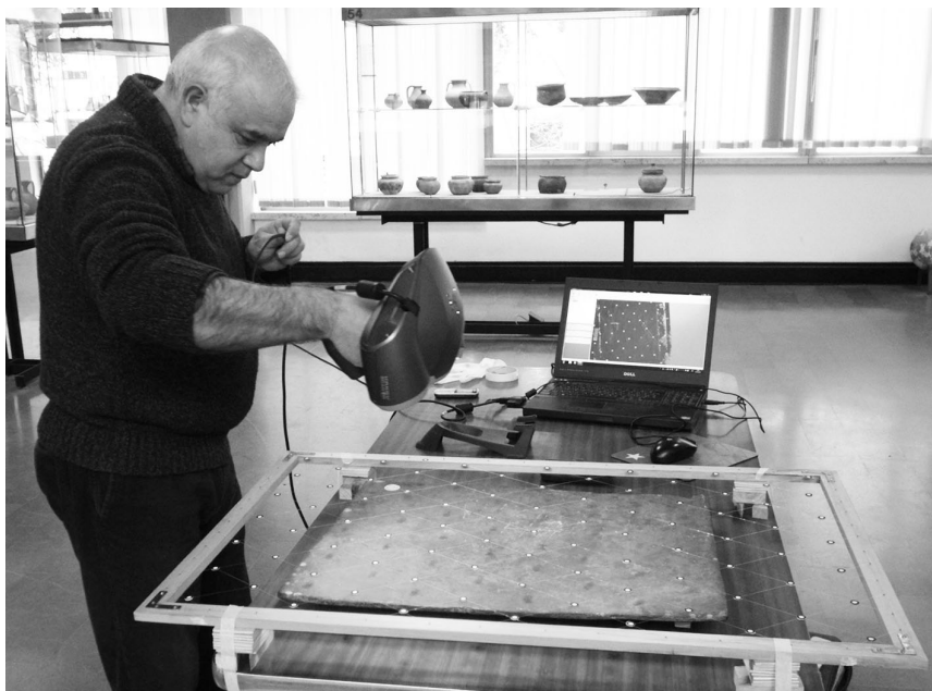
FIG. 6 Rilievo con laser scanner del decreto del proconsole Agrippa ( CIL x, 7852).
