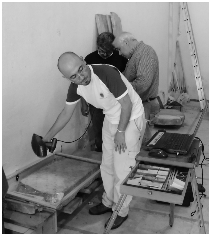
FIG. 2 Rilievo con laser scanner della lastra monumentale dedicata a Aesculapius August(us) ( CIL X, 7552).
